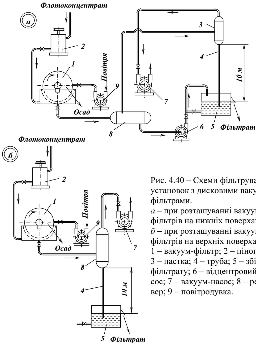
Рис. 4.40 – Схеми фільтрувальних установок з дисковими вакуум-фільтрами.
