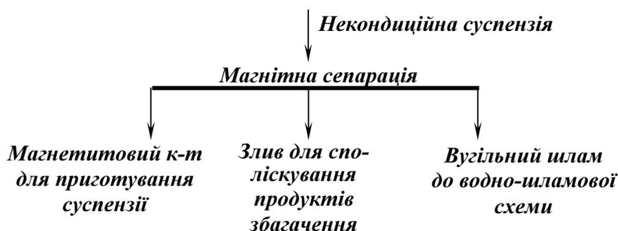
Рис. 3.13 – Одностадійна схема регенерації магнетитової суспензії.
