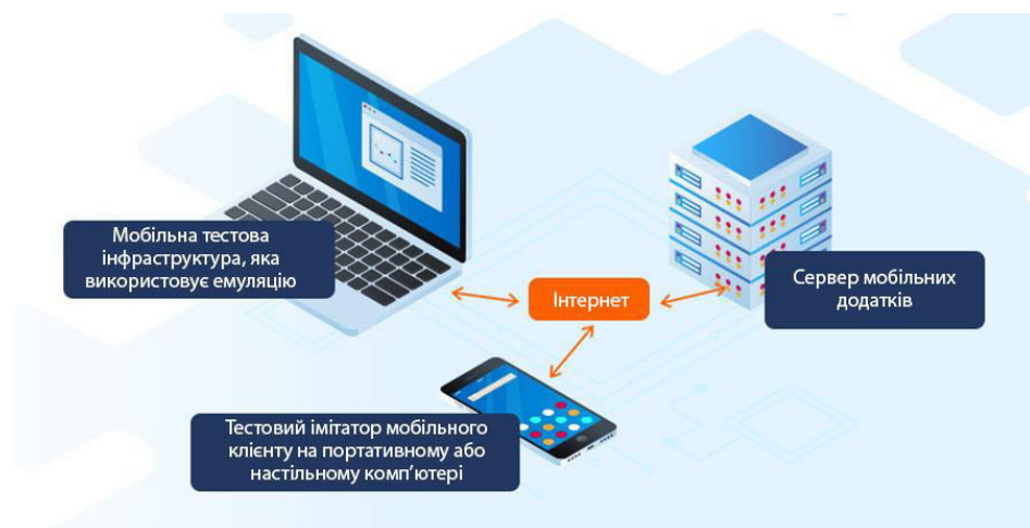
Рисунок 4.1 – Схема тестування на основі емуляції
