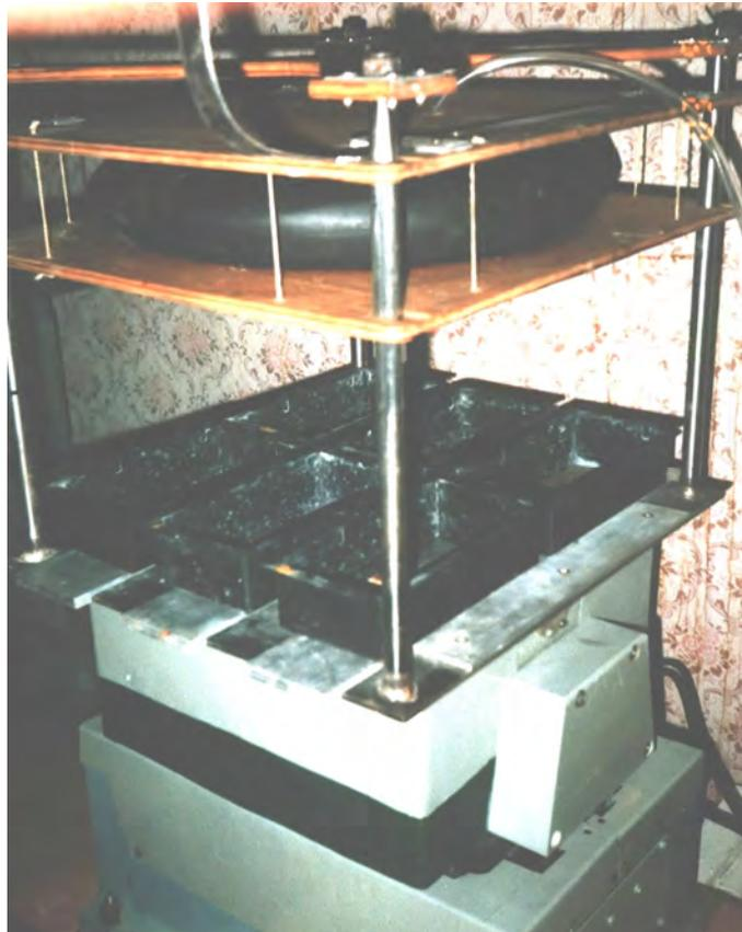
Рисунок 5 – Віброплощадка для виготовлення тротуарної плитки
