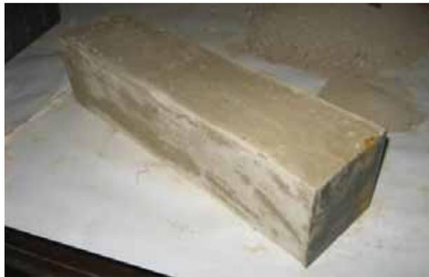
Рисунок 3 – Зовнішній вигляд армованого ґрунтоцементного зразка
