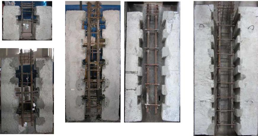
Рис. 2. Зразки після першого етапу бетонування
