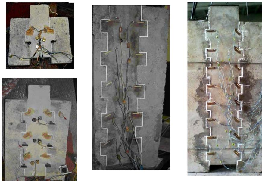
Рис. 4. Схема розташування тензорезисторів на бетоні дослідних зразків
