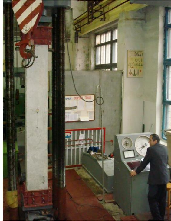
**Випробування колон каркасів для будівництва 16-квартирних житлових будинків у м. Полтаві**
