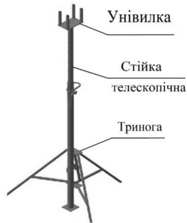
**Рис. 2. Конструкція стійки**
