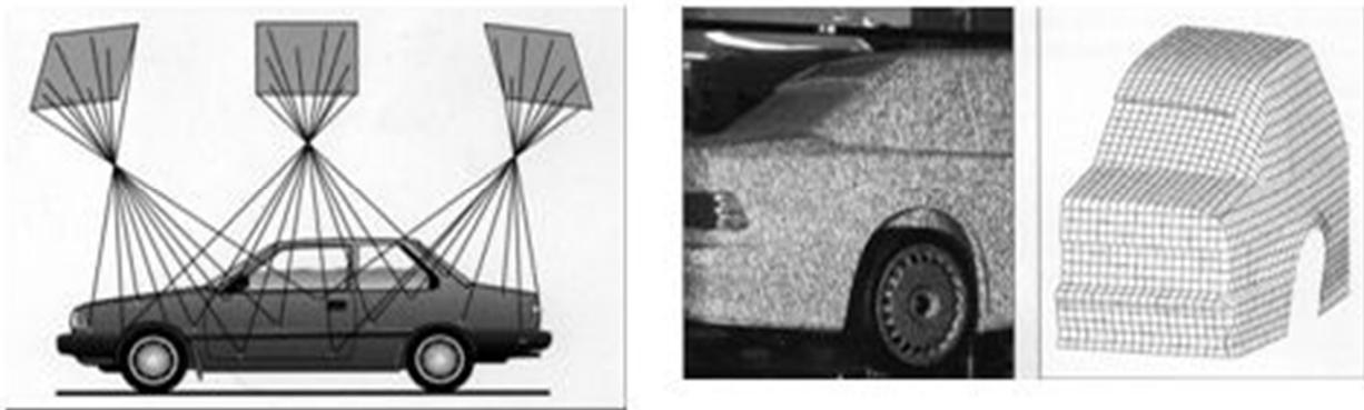
**Рис. 2. Побудова цифрових моделей поверхні методами ближньої фотограмметрії**
