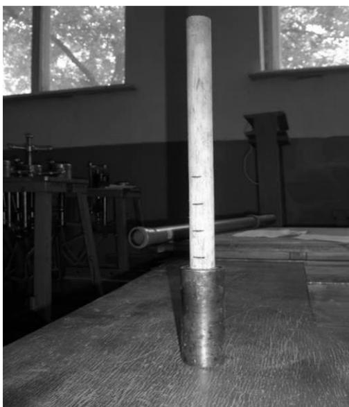
**Рис. 1** Ручна трамбівка для ущільнення ґрунту
