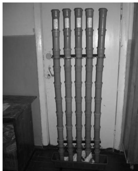
**Рис. 2** Труби, заповнені ущільненим ґрунтом з позначенням даних вгорі щодо вихідної щільності скелета ґрунту  $\rho_d$  та його заданої вологості  $w$
