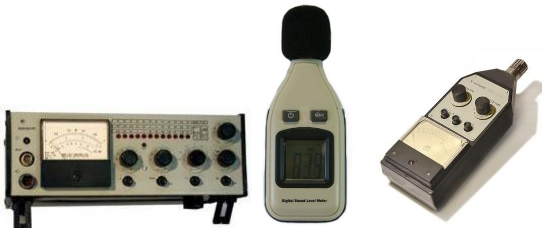
**Рис. 7.4.** Прилади для вимірювання шуму і вібрації:
