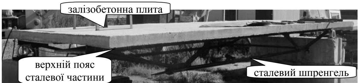
Рис. 1.22 – Однопролітна сталезалізобетонна шпренгельна конструкція [98]
