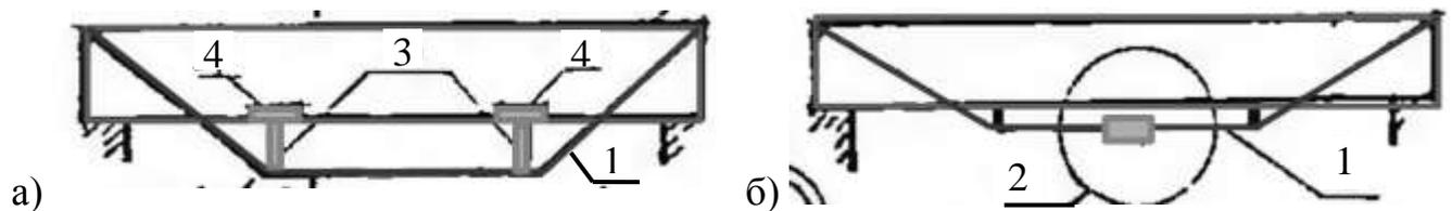
Рис. 1.6 – Типові конструктивні рішення [134] зовнішнього підсилення залізобетонних конструкцій сталевими тяжами (шпренгелями) (поз. 1) із натягом останніх шляхом: а) підклинюванням сталевими пластинами (поз. 3-4); б) стяжною муфтою (поз. 2)
