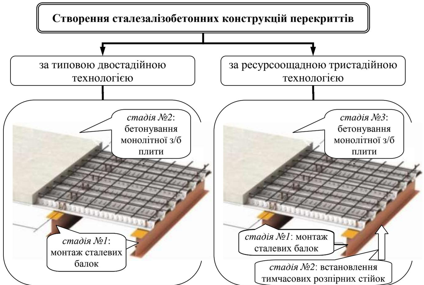
Рис. 4.1 – Багатостадійна технологія створення сталезалізобетонних перекриттів
