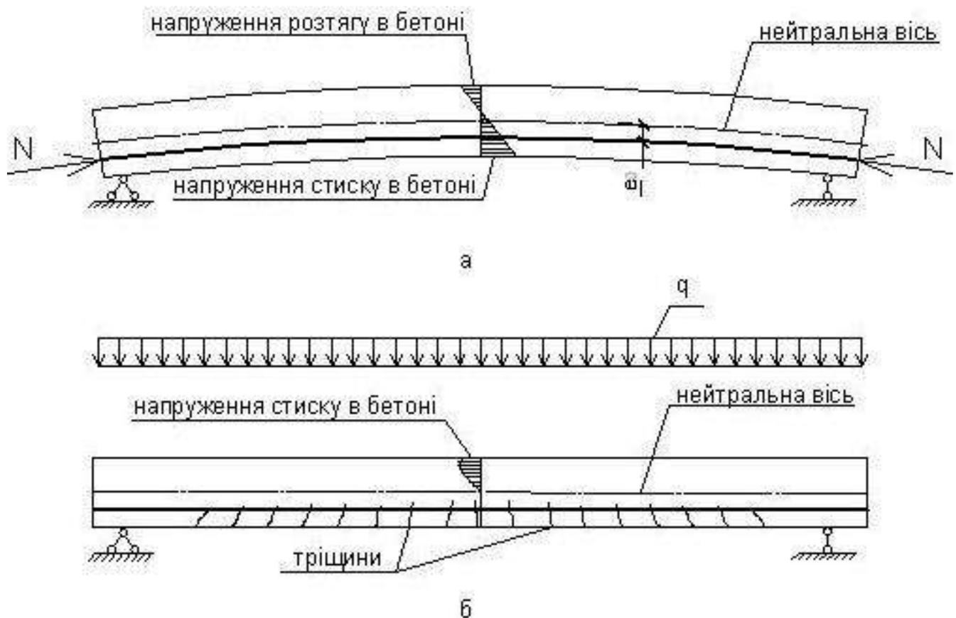
Рис. 1.33 – Принцип створення попередніх напружень у залізобетоні [144]:
