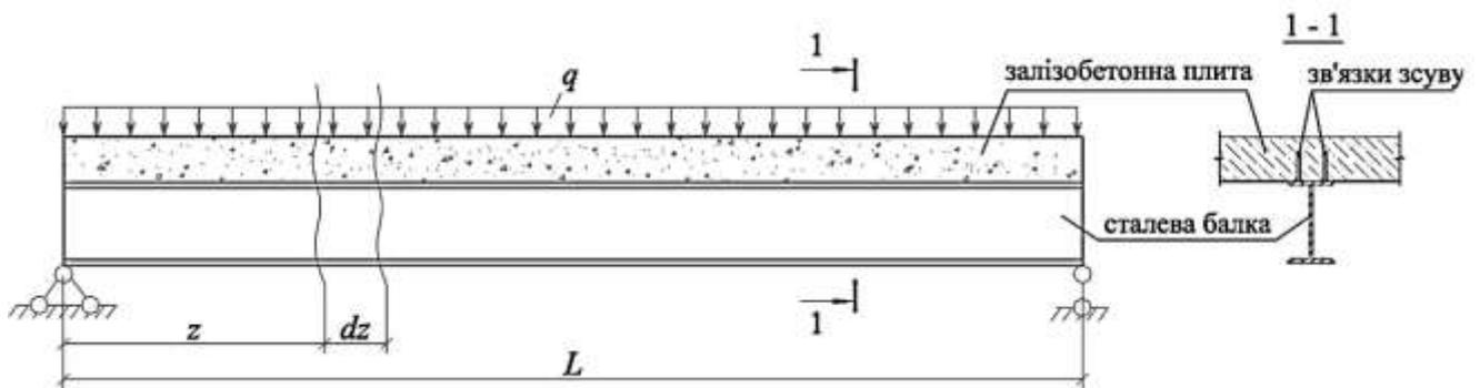
Рис. 3.4 – Загальний вигляд двошарової сталезалізобетонної стержневої конструкції
