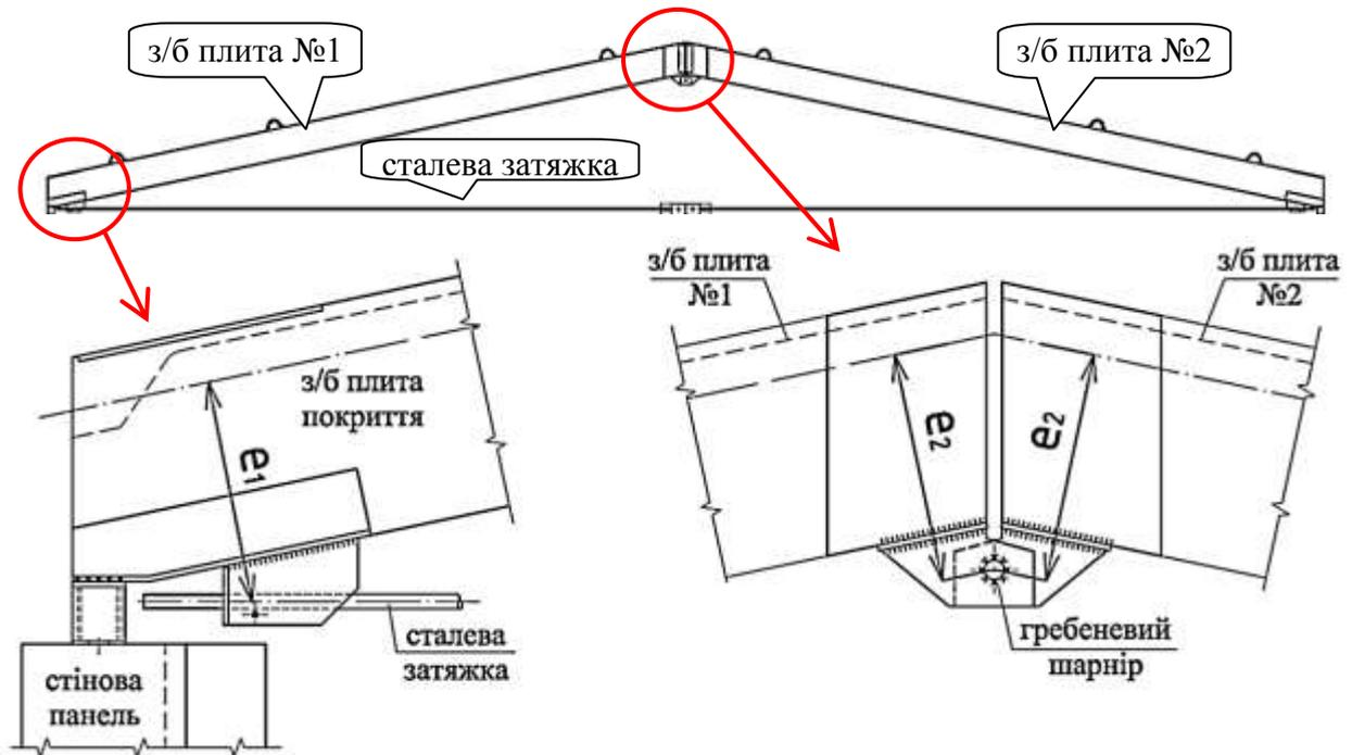
Рис. 6.7 – Схематичне зображення екцентричних вузлів з'єднання конструктивних елементів кроквяної системи, за допомогою яких можливо створювати розвантажувальні опорні моменти у залізобетонних плитах
