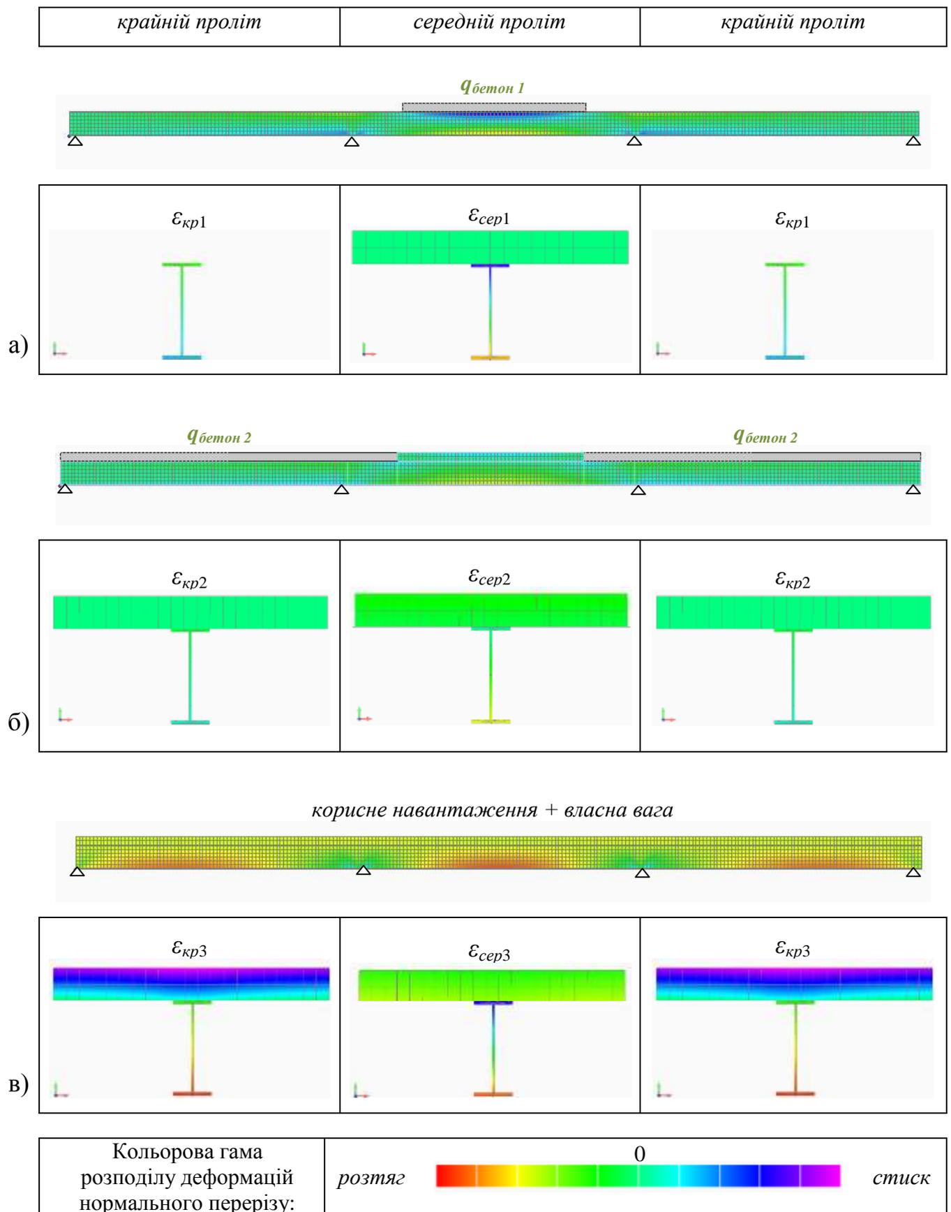
Рис. 5.13– Розподіли відносних деформацій під час двостадійного створення самоупругених згинаних СЗБК, визначені скінченно-елементним моделюванням:
