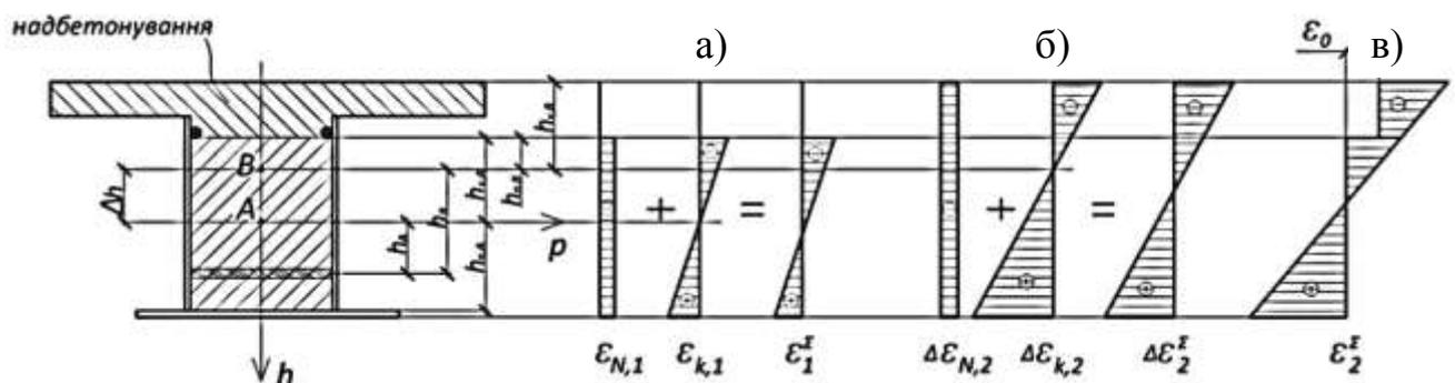
Рис. 1.14 – Епюри відносних деформацій у сталезалізобетонному ригелі [174]:
