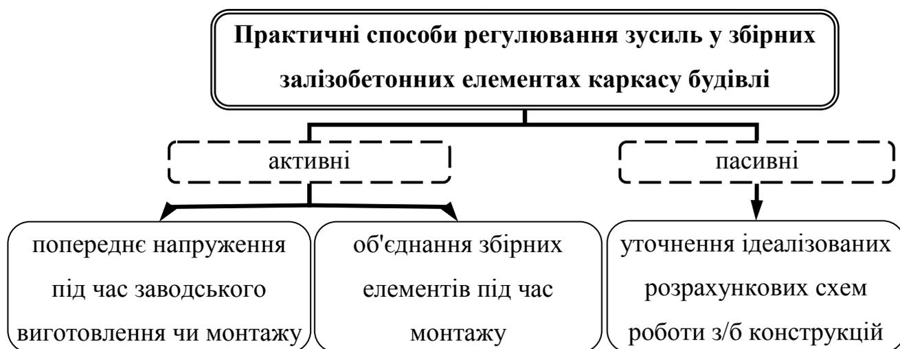
Рис. 1.32 – Способи регулювання зусиль у збірних залізобетонних конструкціях
