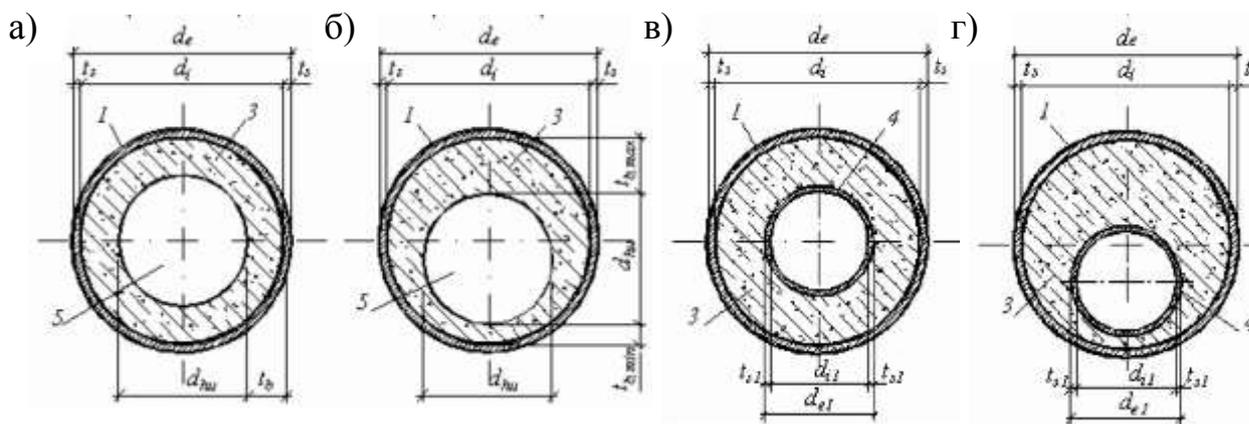
Рис. 1.27 – Перерізи трубобетонних елементів із центрифугованим бетонним осердям [94]: 1 – сталева зовнішня труба-оболонка; 3 – центрифугований бетон; 4 – внутрішня труба; 5 – внутрішня порожнина
