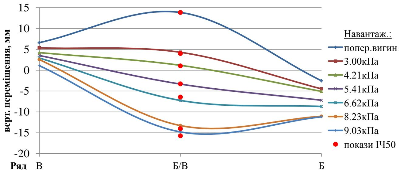
Рис. 4.36 – Вертикальні переміщення балки ПСБЗ.2 (розташування див. рис. 4.32)
