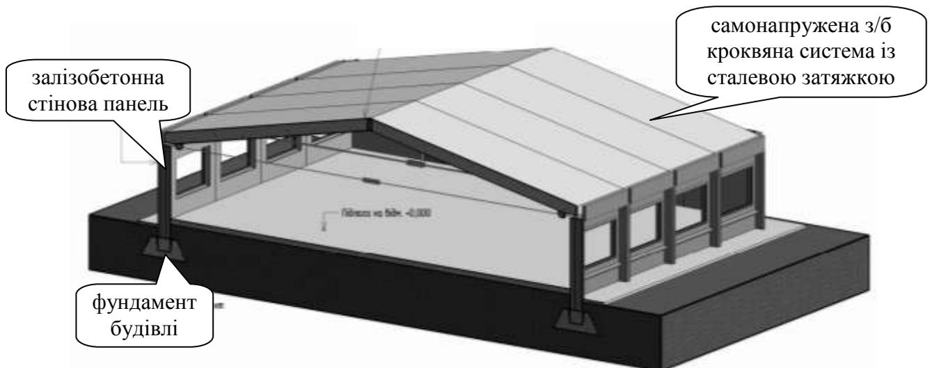
Рис. 6.2 – Стінова конструктивна схема швидкокомтованих будівель
