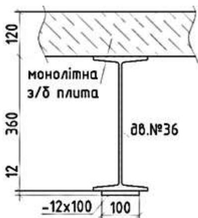
Рис. 3.19 – Поперечний переріз сталезалізобетонних балок серії ПСБЗ
