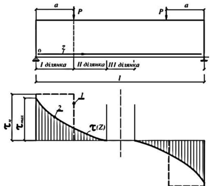
Рис. 1.47 – Уточнена еюра (поз.2) дотичних напружень (б) вздовж поверхні шва двокомпонентного ЗБЕ (а) при несумісності деформацій бетону і арматури [300]
