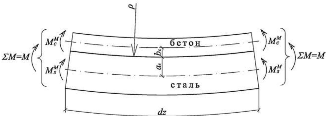
Рис. 4.7 – До визначення частин згинальних моментів від дії зовнішнього навантаження, що сприймаються окремо кожним шаром сталезалізобетонної балки
