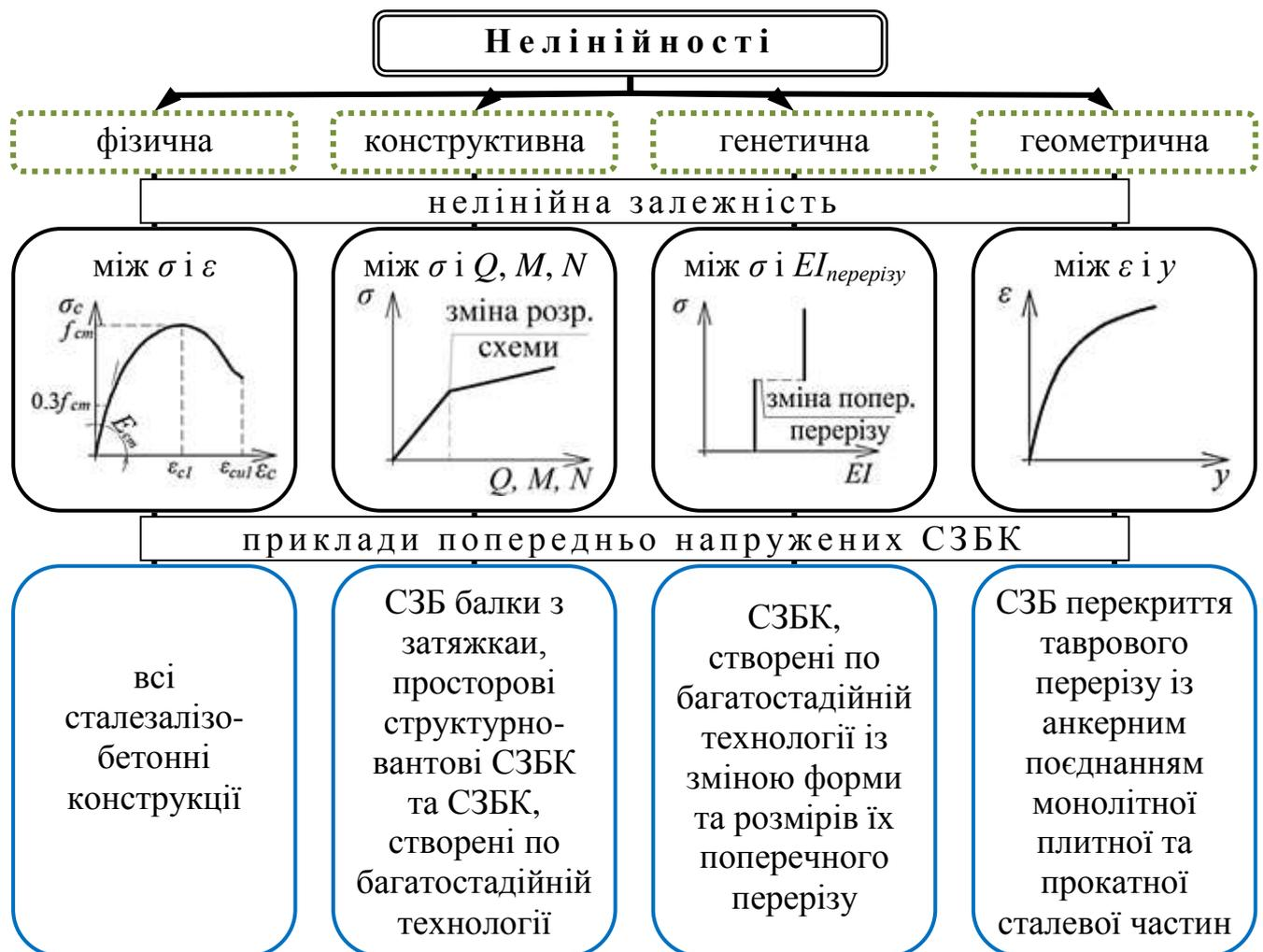
Рис. 1.43 – Нелінійності під час створення та експлуатації попередньо напружених сталезалізобетонних конструкцій
