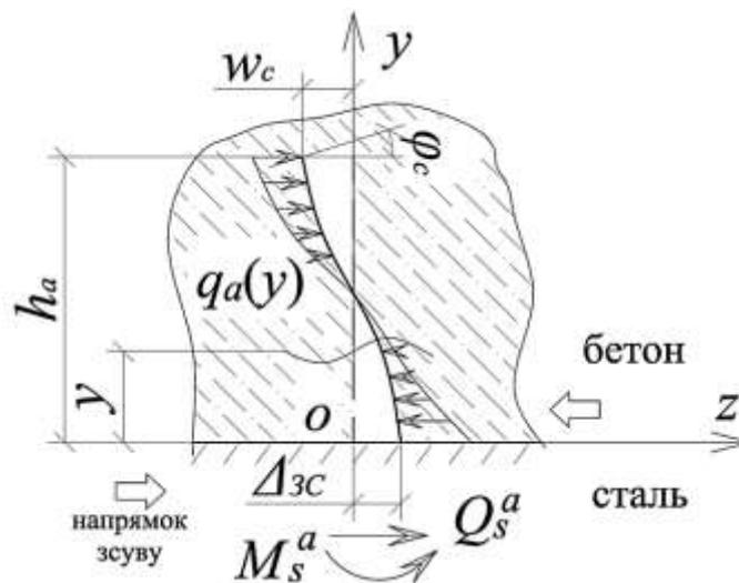
Рис. 3.8 – Розрахункова схема анкера в бетоні
