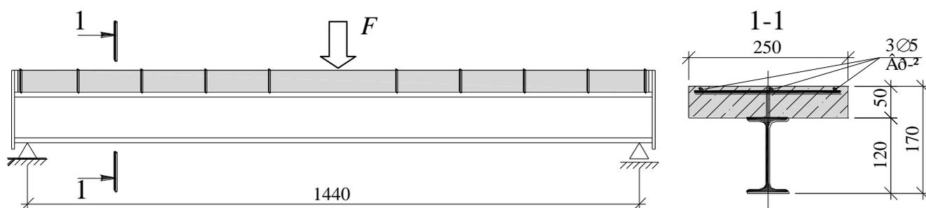
Рис. 3.9 – Геометричні параметри однопролітної сталезалізобетонної балки Б4
