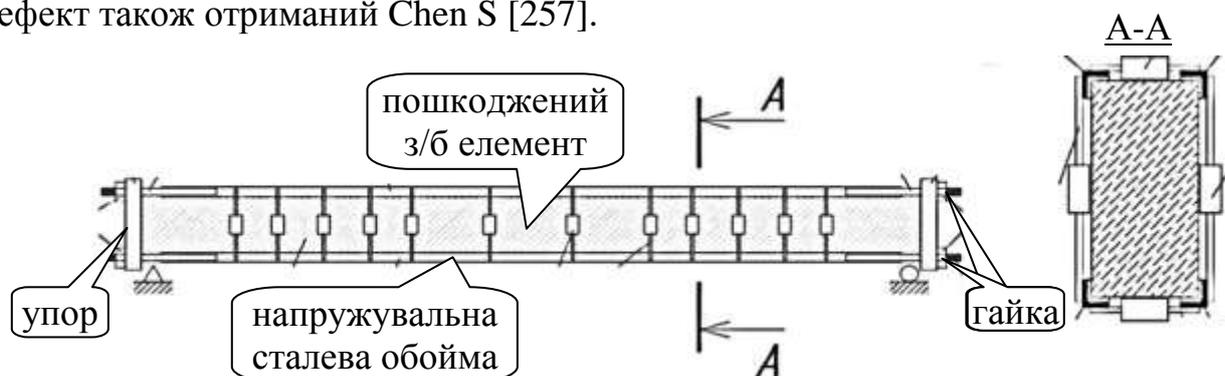
Рис. 1.39 – Схема підсилення пошкодженої з/б балки сталевими обоймами [294]
