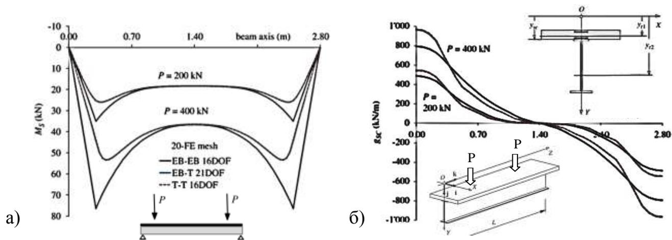
Рис. 1.17 – Графіки розподілу по довжині конструкції [234]: а) згинаючого моменту у сталевій частині; б) зсувного зусилля у контактному шві
