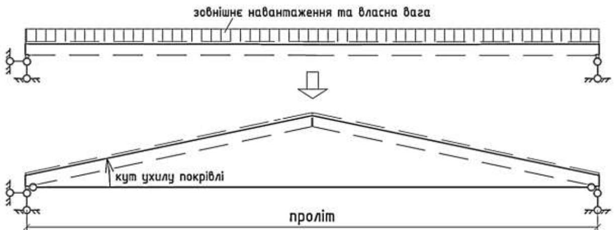
Рис. 6.9 – Трансформація залізобетонної трикутної кроквяної системи із зтяжкою при збільшенні кута нахилу покрівлі
