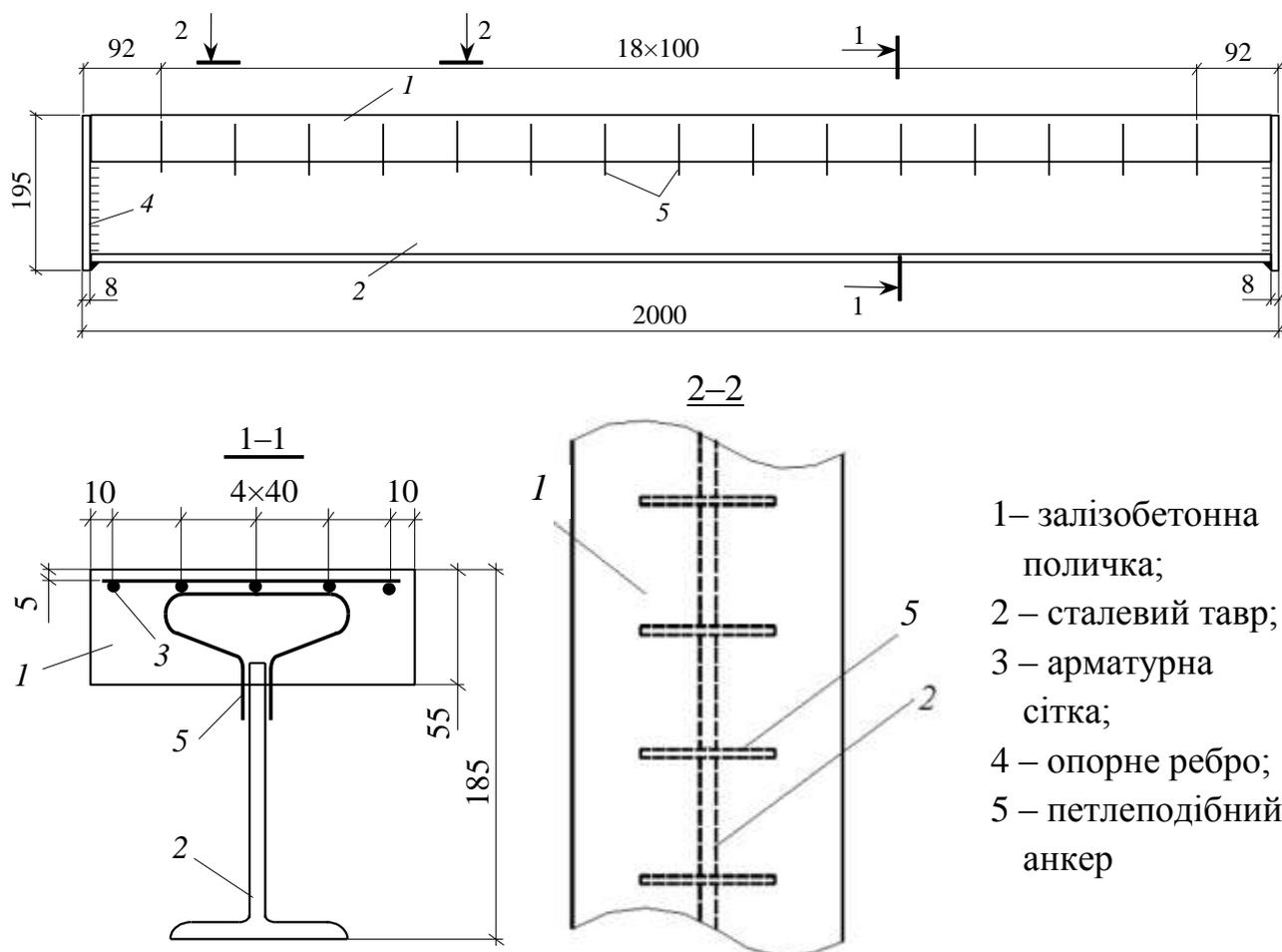
Рис. 3.12 – Геометричні параметри однопролітної сталезалізобетонної балки СБ2
