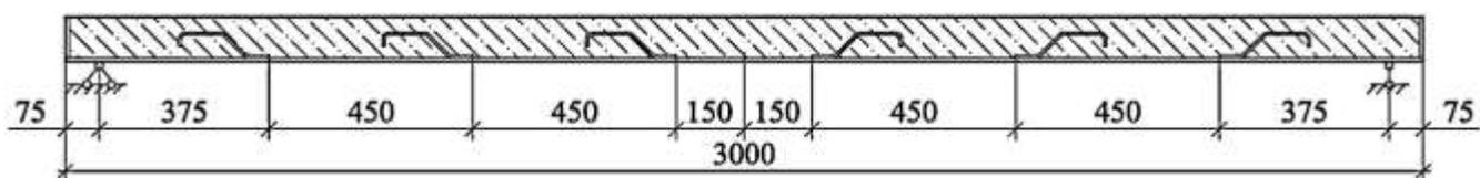
Рис. 3.17 – Схема розміщення додаткових анкерів по довжині балок
