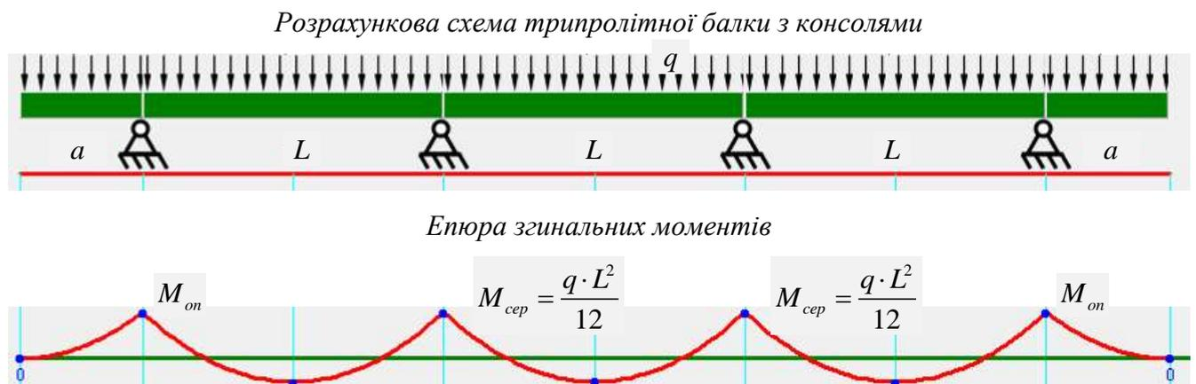
Рис. 5.3 – До визначення довжин консолей трипролітної балки
