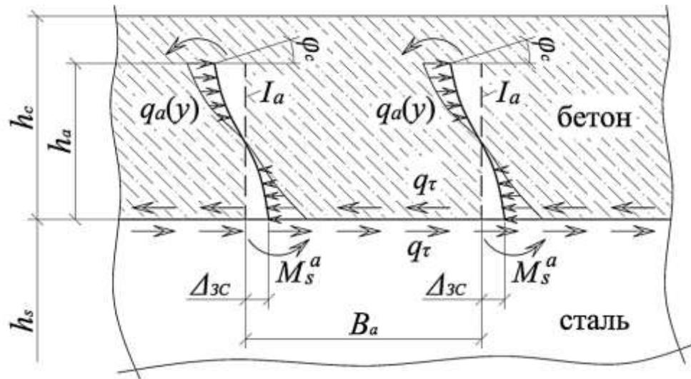
Рис. 3.7 – Фрагмент сталевого і бетонного шарів при їх відносному зсуві на величину  $\Delta_{зс}$  та анкерних засобів між ними ( $I_c, I_s, I_a$  – моменти інерції відповідно бетонного і сталевого шарів та анкерних засобів у площині їх згину)
