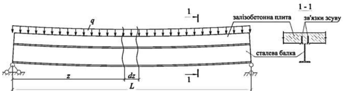
Рис. 4.4 – Загальний деформований вигляд двошарової сталезалізобетонної стержневої конструкції, що працює на поперечний згин
