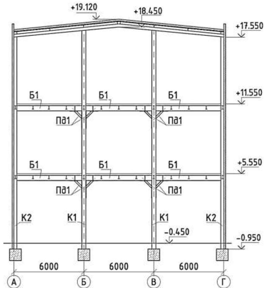
Рис. 7.1 – Схематичний поперечний розріз трипролітної триповерхової виробничої будівлі
