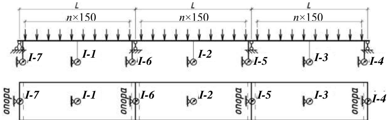
Рис. 5.30 – Схема встановлення індикаторів годинникового типу ІЧ-10
