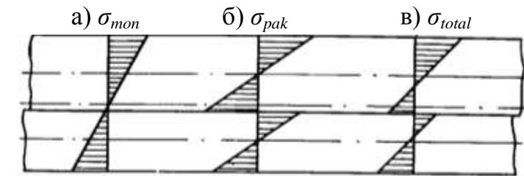
Рис. 1.45 – Розподіли напружень у перерізах двошарового стержня із зв'язками зсуву: а) повністю жорсткими; б) відсутніми; в) гнучкими [18]
