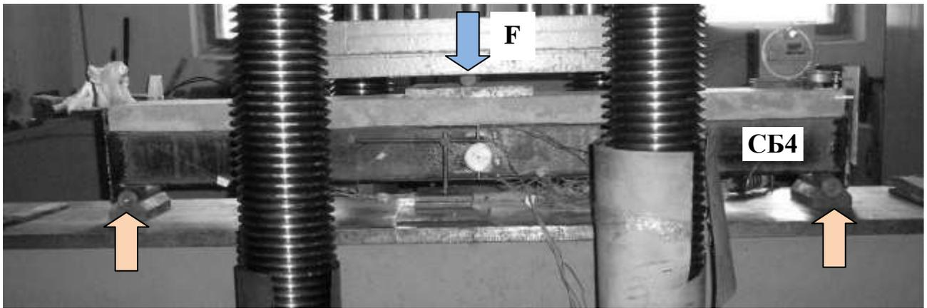
Рис. 4.12 – Сталезалізобетонна балка серії СБ4 під час випробувань
