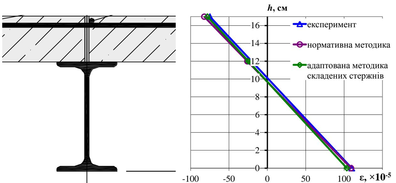
Рис. 4.15 – Порівняння деформацій нормального перерізу балок серії СБ4
