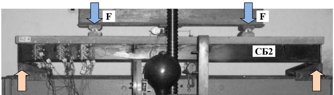
Рис. 4.16 – Сталезалізобетонна балка серії СБ2 під час випробувань
