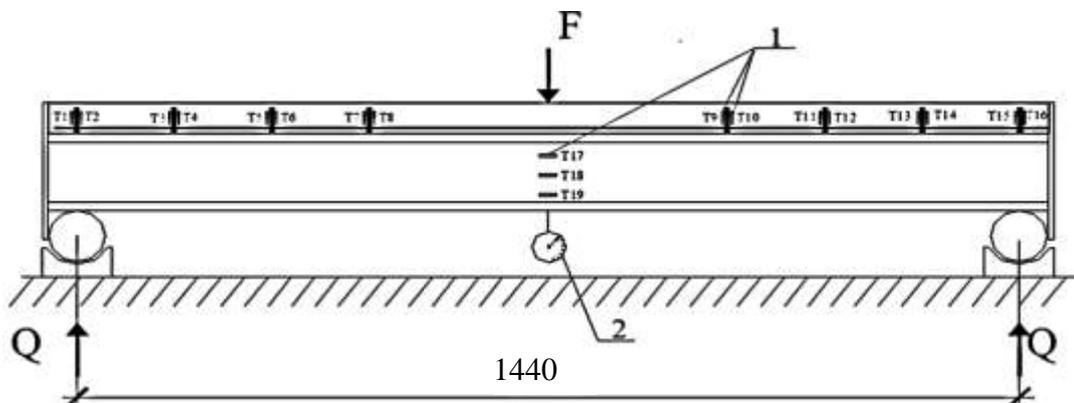
Рис. 4.13 – Схема завантаження та розміщення вимірювальних приладів під час дослідження роботи сталезалізобетонної балки серії СБ4:
