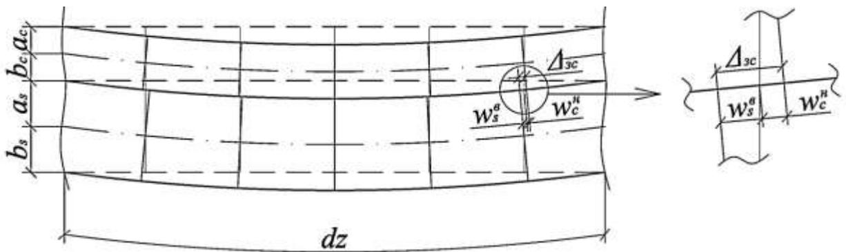
Рис. 4.10 – До визначення зміщень (взаємного зсуву  $\Delta_{zc}$ ) верхнього волокна нижче розташованого шару  $w_s^g$  та нижнього волокна вище розташованого шару  $w_c^h$
