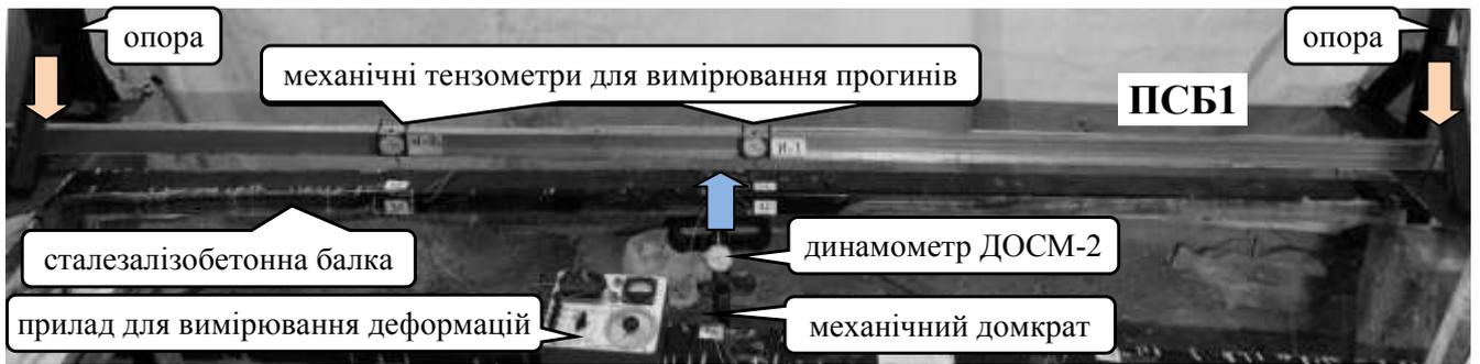
Рис. 4.23 – Загальний вигляд сталобетонних зразків під час випробувань
