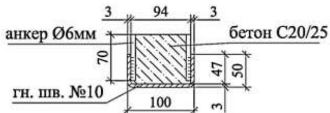
Рис. 3.16 – Геометричні параметри однопролітних сталезалізобетонних балок
