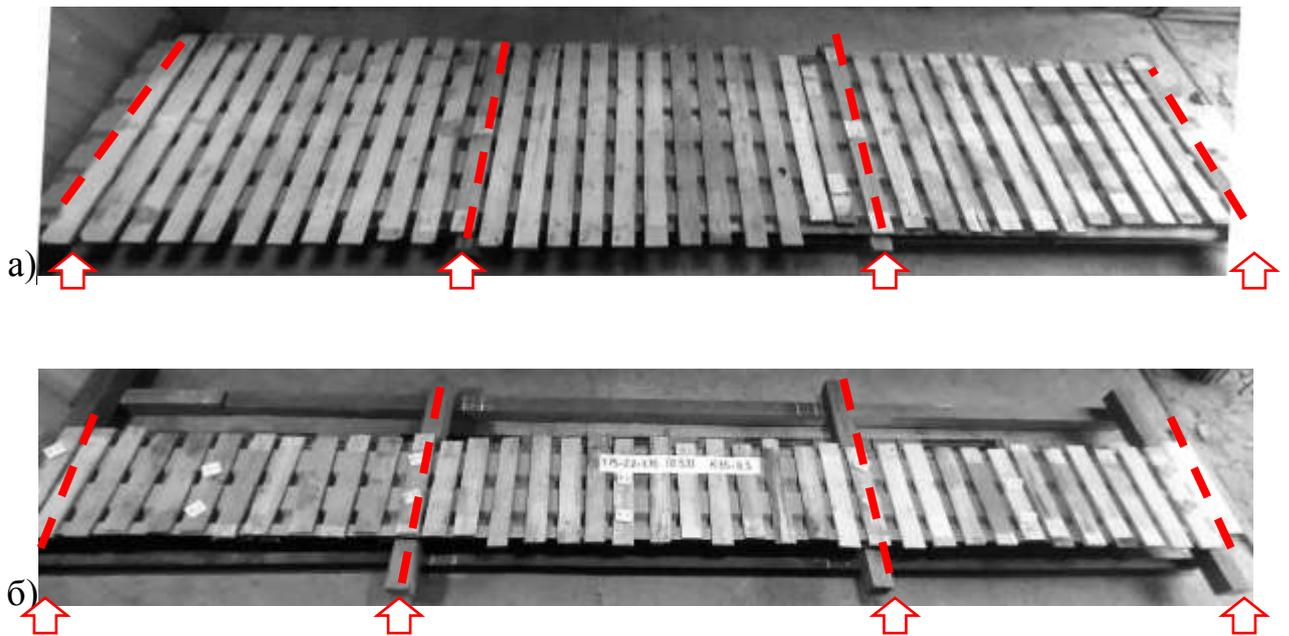
Рис. 5.17 – Загальний вигляд розташування дерев'яних прокладок під час випробування зразків профільованого настилу марки К35-0,5 довжиною 6000 мм:
