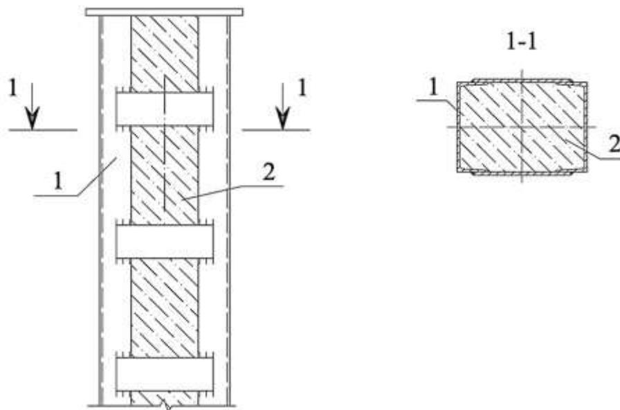
Рис. 7.21 – Підсилювана сталева колона під час бетонування
