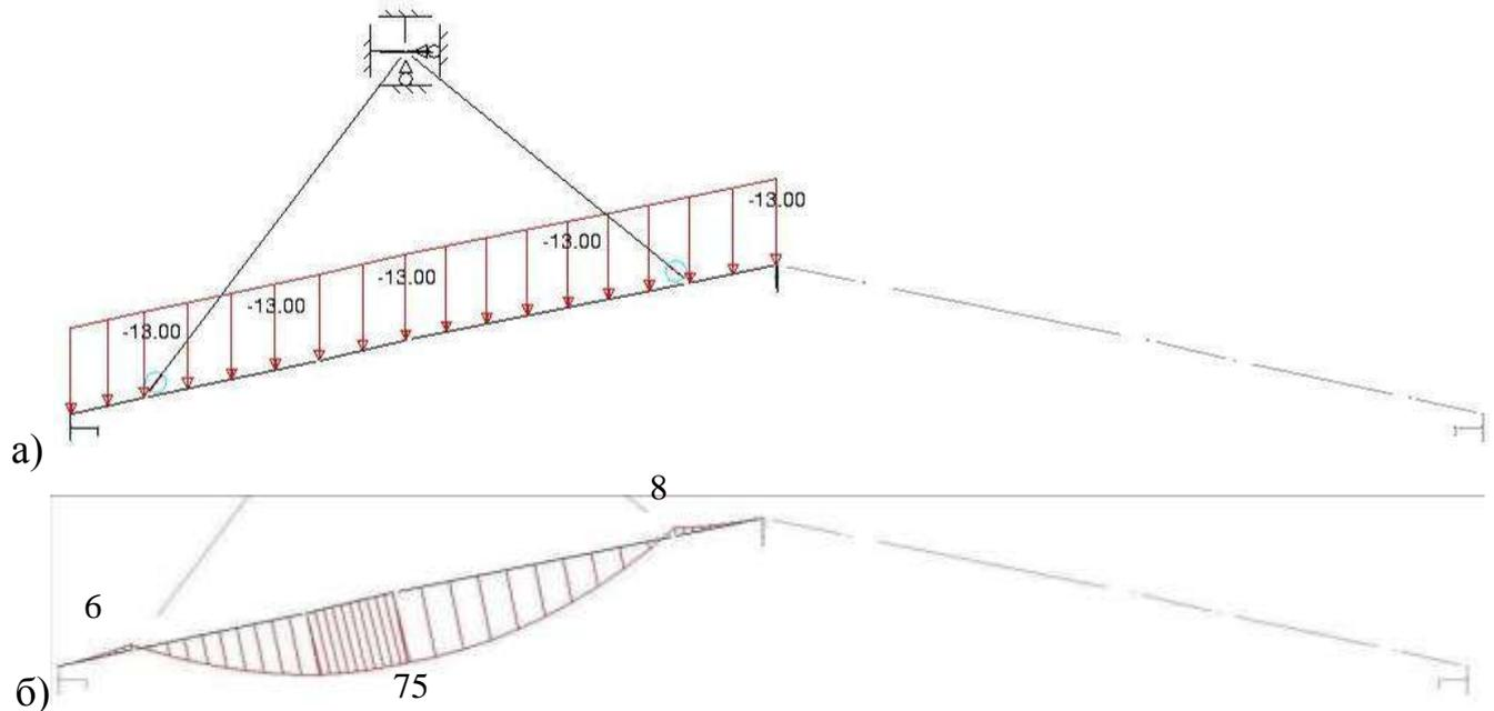
Рис. 6.16 – Підйом однієї напівпанелі за монтажні петлі:
