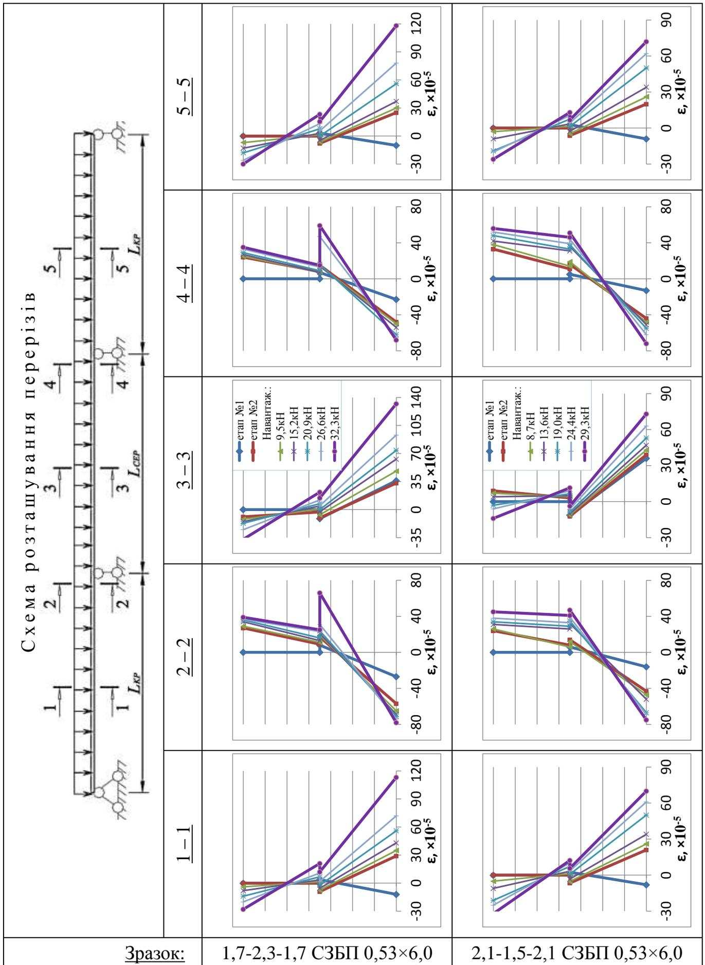
Рис. 5.36 – Розподіли деформацій нормальних перерізів зразків СЗБ плит
