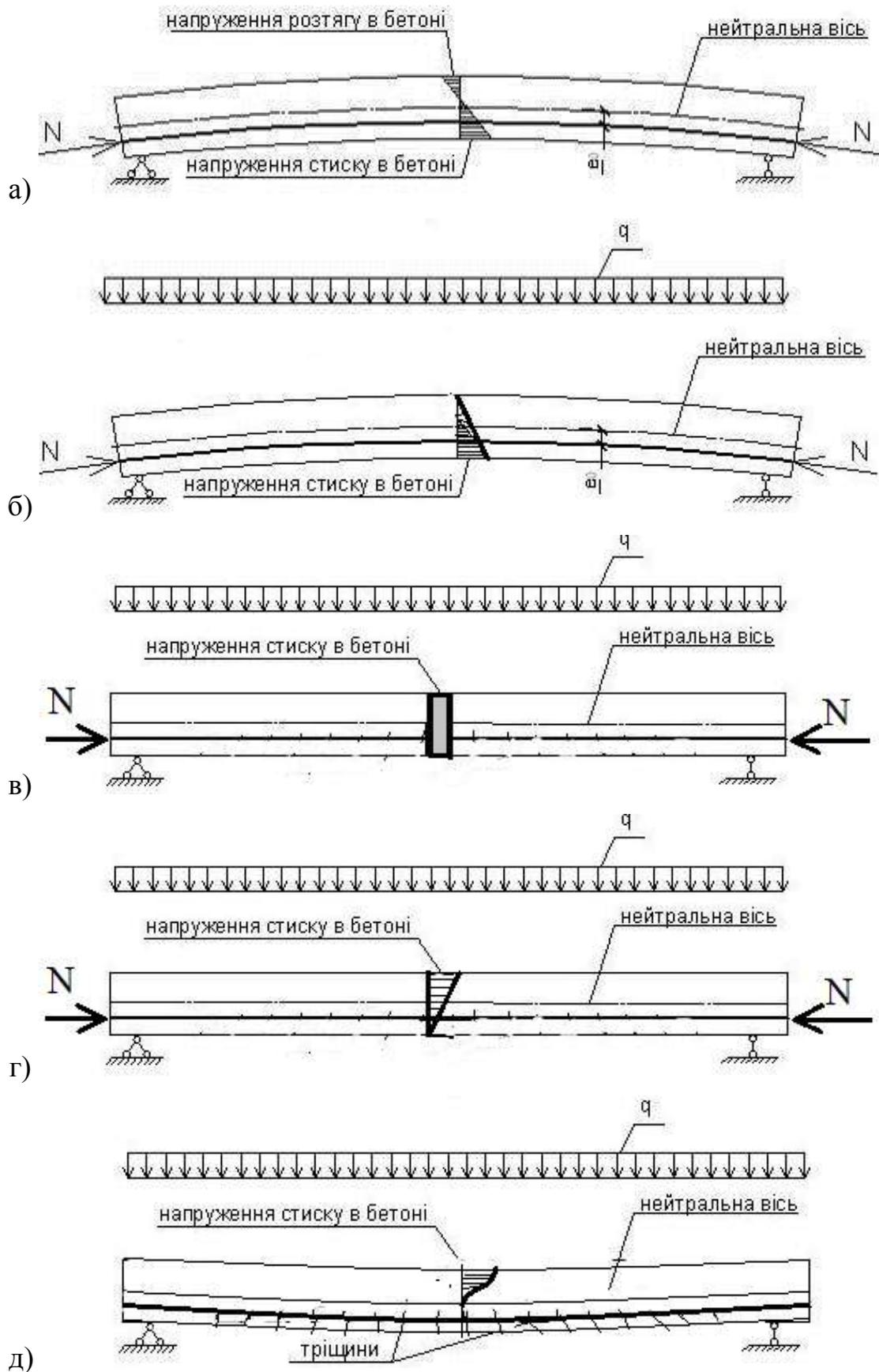
Рис. 6.8 – Стадії роботи попередньо напруженої залізобетонної плити перекриття:
