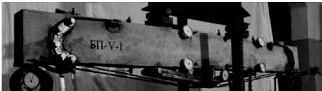
Рис. 1.4 – Вигляд з/б балки, підсиленої стрижнево-котковою системою [217]
