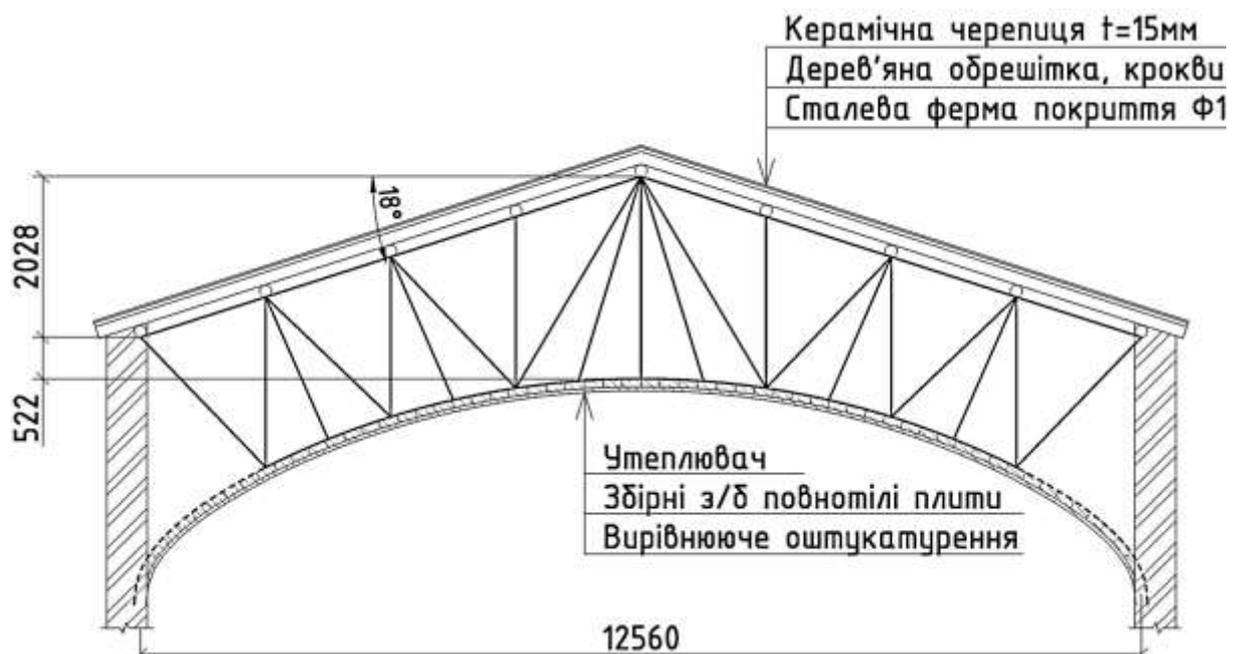
Рис. 6.23 – Схематичний поперечний розріз просторової системи покриття
