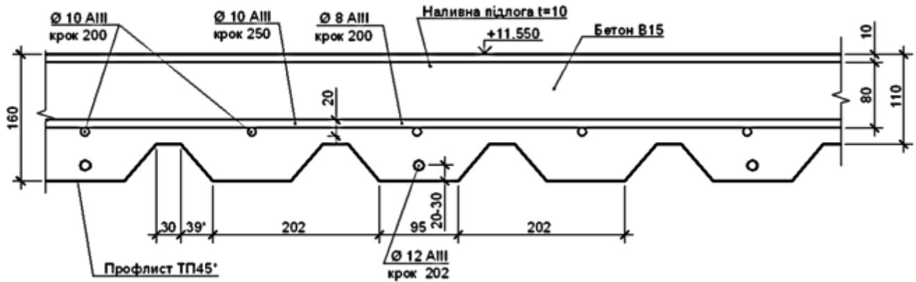
Рис. 7.5 – Армування монолітної залізобетонної плити СЗБ перекриття
