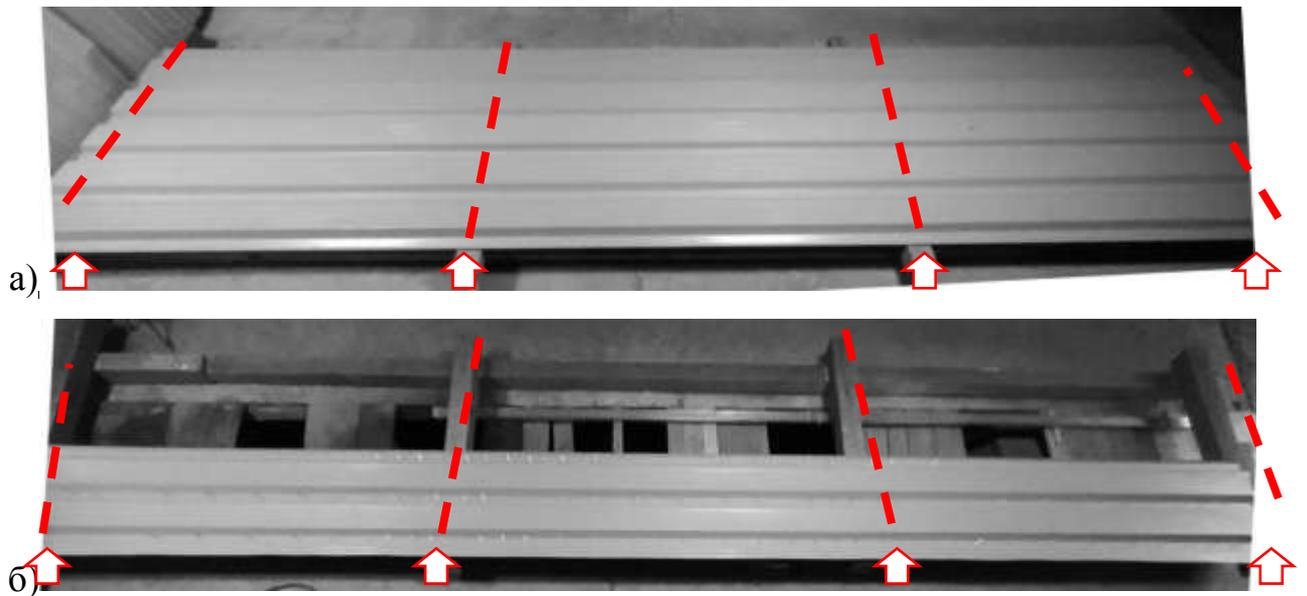
Рис. 5.15 – Загальний вигляд експериментально досліджених листів профільованого настилу марки К35-0,5 довжиною 6000 мм:
