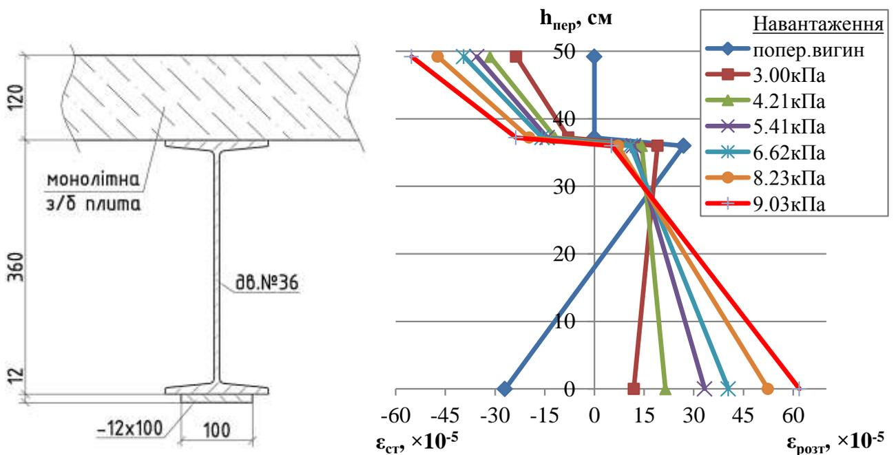
Рис. 4.34 – Зміна відносних деформацій по висоті перерізу балки серії ПСБ3 на кожному етапі навантаження
