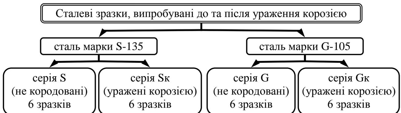
Рис. 2.17 – Схема прийнятої нумерації випробуваних сталевих зразків
