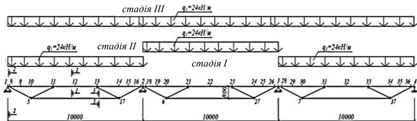
Рис. 1.24 – Схеми завантаження нерозрізної комбінованої конструкції [96; 97]
