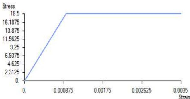
Рис. 2.19 – Спрощений дволінійний закон деформування  $\sigma_c$ - $\varepsilon_c$
