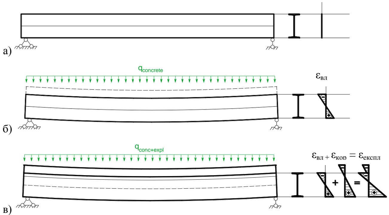
Рис. 4.2 – Стадії роботи комбінованого сталезалізобетонного перекриття, виготовленого за двостадійною технологією: а) монтаж сталевих балок; б) влаштування монолітної плити перекриття; в) експлуатаційна стадія
