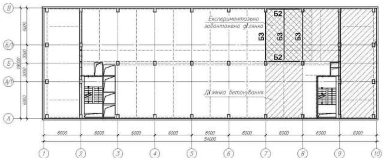
Рис. 4.28 – Схема розташування ділянки сталезалізобетонного перекриття третього поверху будівлі в осях 7-8/Б-В
