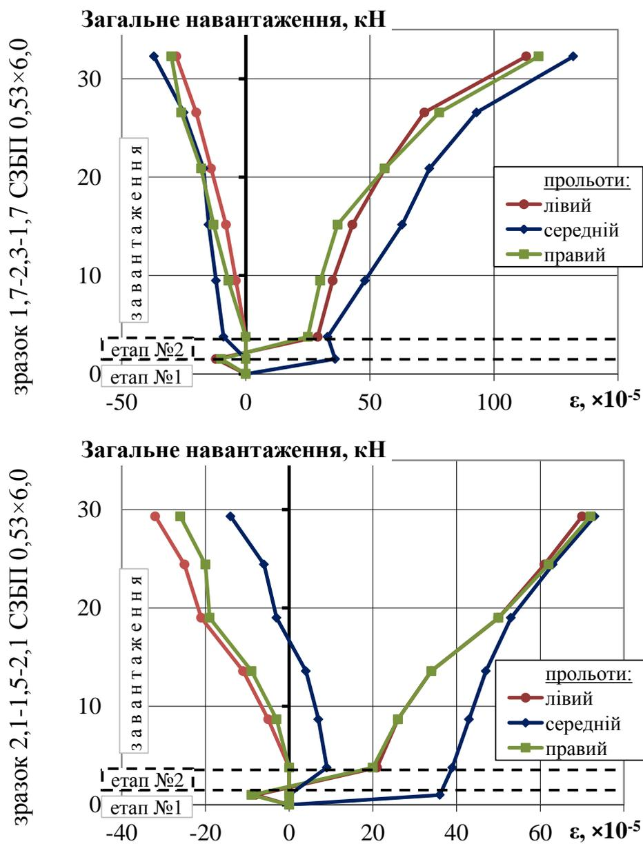
Рис. 5.35 – Прирости відносних деформацій нижньої і верхньої фібри перерізу
