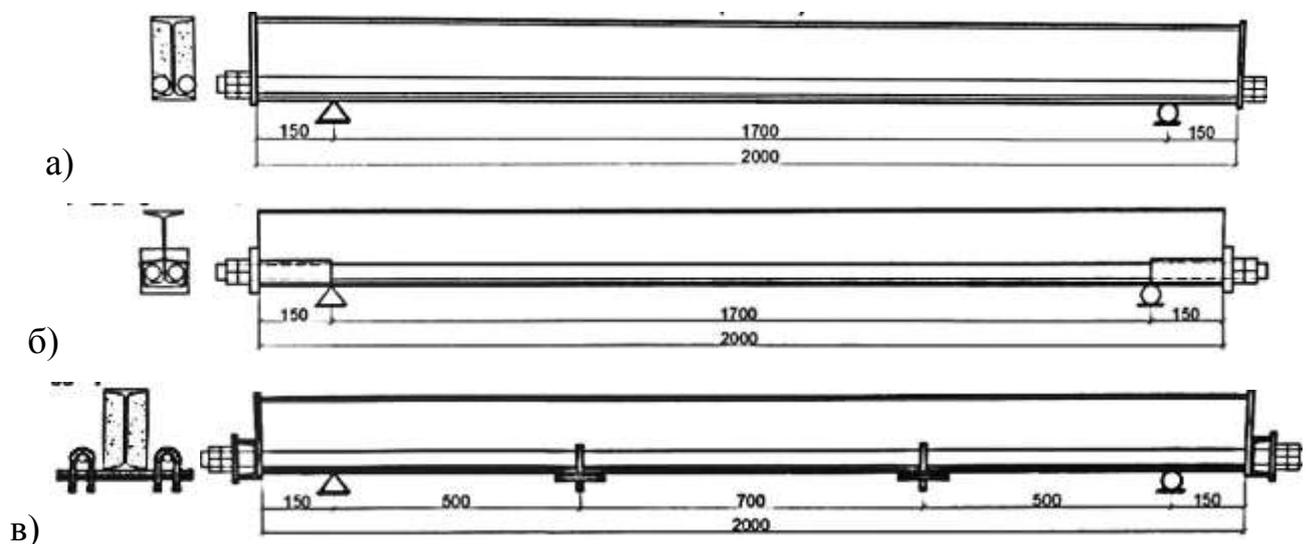
Рис. 1.10 – Схеми додаткового попередньо напруженого внутрішнього (а-б) та зовнішнього (в) армування сталобетонних балок [124]
