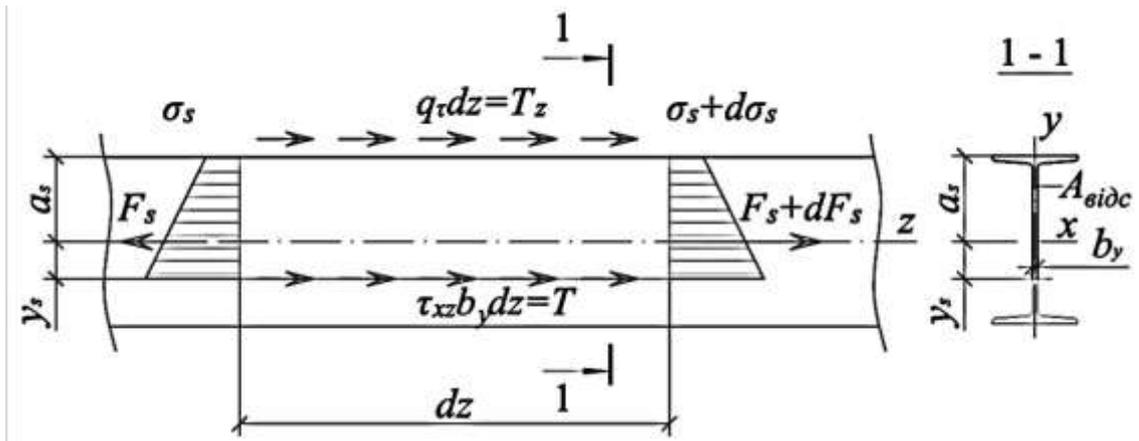
Рис. 4.11 – Вирізна ділянка сталевго двотавра довжиною  $dz$  та висотою  $y_s + a_s$  із позначеними зусиллями для визначення дотичних напружень  $\tau_{xz}$
