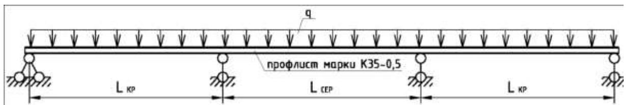
Рис. 5.16 – Розрахункова схема завантаження зразків листів профільованого настилу за трипролітною нерозрізною схемою
