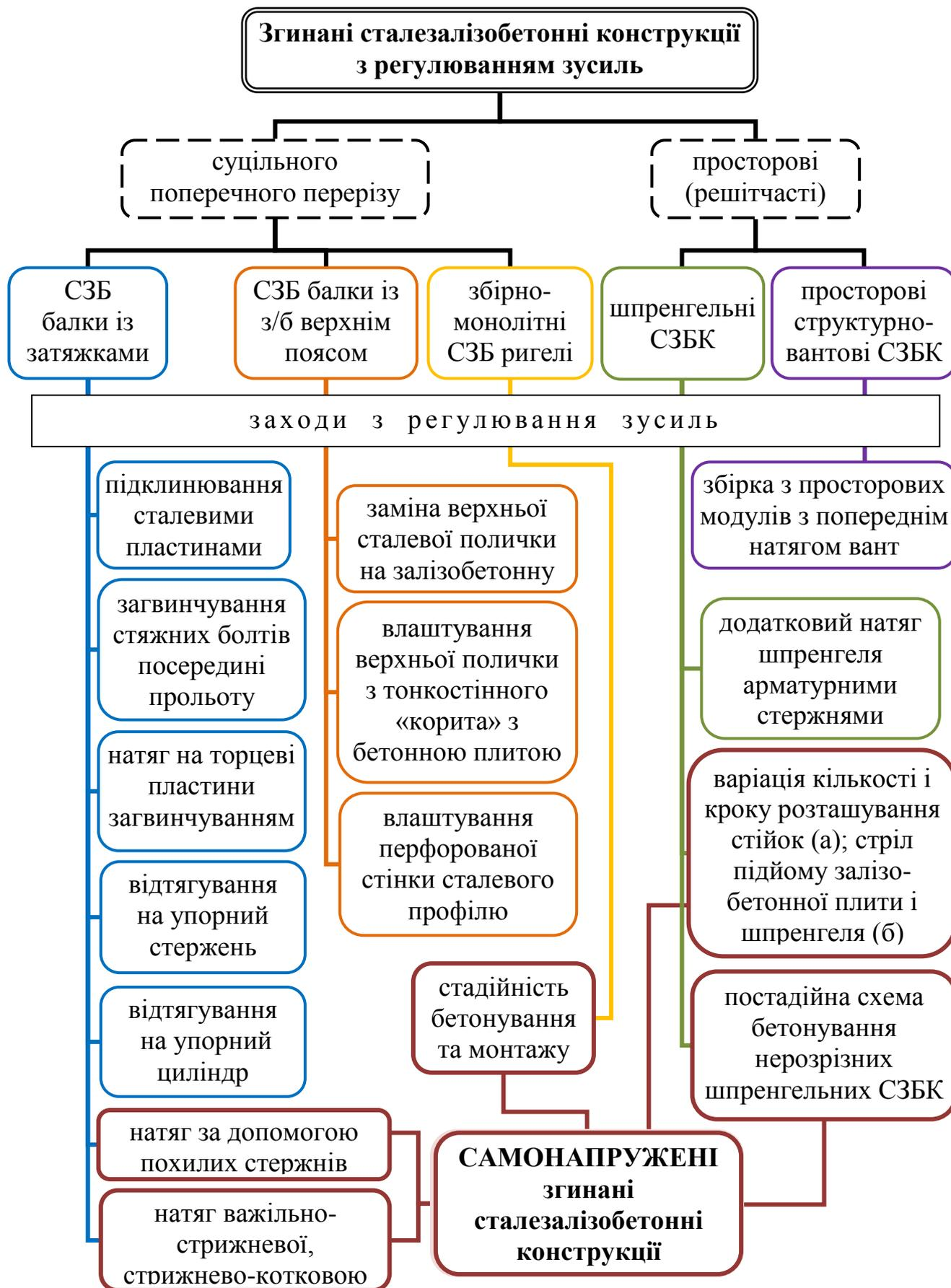
Рис. 1.1 – Заходи з регулювання зусиль у згинаних сталезалізобетонних конструкціях
