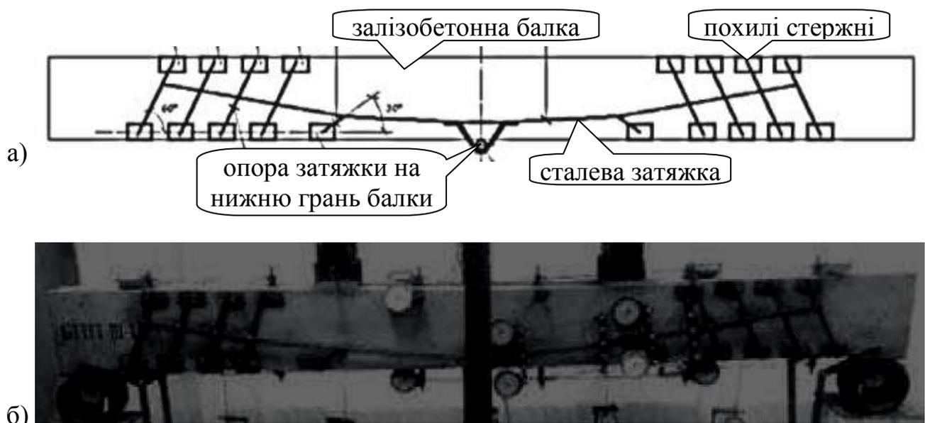
Рис. 1.2 – Конструкція регульовано-напруженої з/б балки: а) схема розташування системи поздовжньо-поперечних затяжок; б) фото під час випробування [215]
