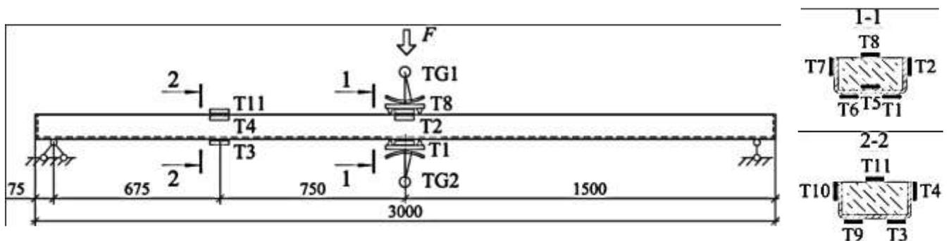
Рис. 4.24 – Схема розташування вимірювальних приладів на зразках
