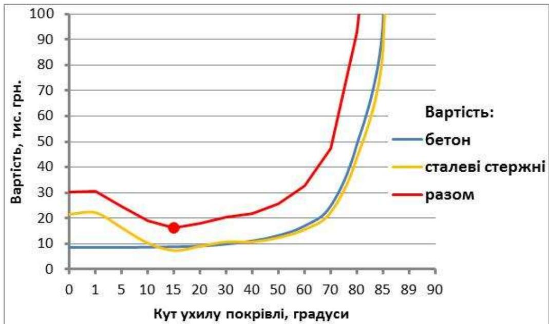
Рис. 6.14 – Графік зміни вартості покрівельної кроквяної системи в залежності від ухилу покрівлі
