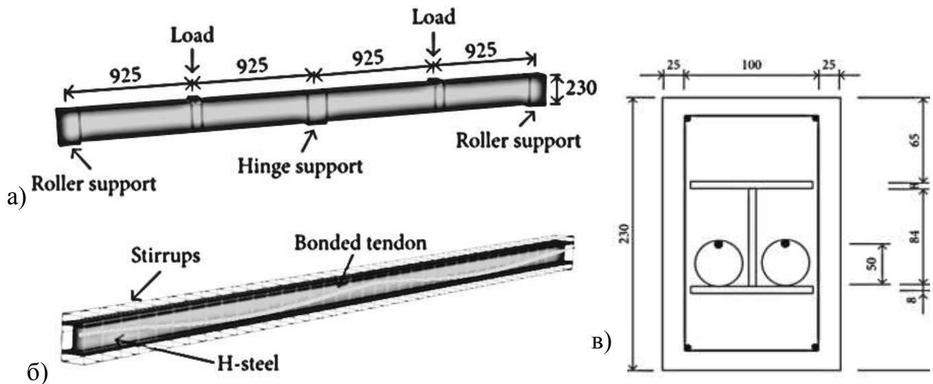
Рис. 1.11 – Попередньо напружені сталезалізобетонні балки [353]:
