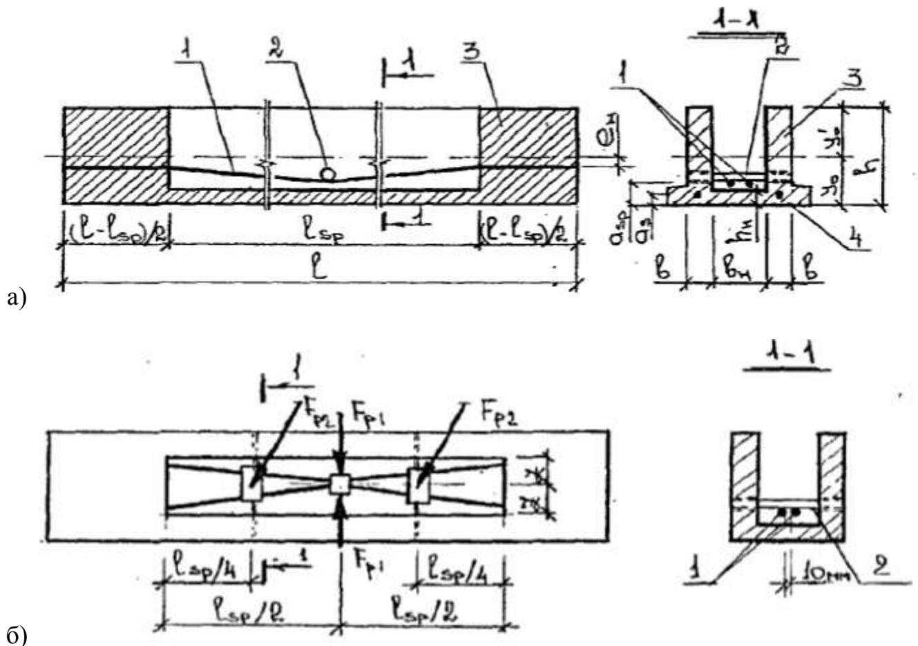
Рис. 1.8 – Локально попередньо напружена шпренгелем балка збірно-монолітного сталезалізобетонного перекриття [139]: а) будова; б) схема двоетапного натягу арматури; 1 – напружувана арматура; 2 – упорний стержень; 3 – залізобетонна частина балки; 4 – ненапружувана арматура
