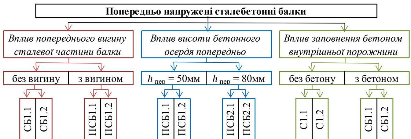
Рис. 4.22 – Схема досліджень сталобетонних балок серій СБ1, ПСБ1 і ПСБ2
