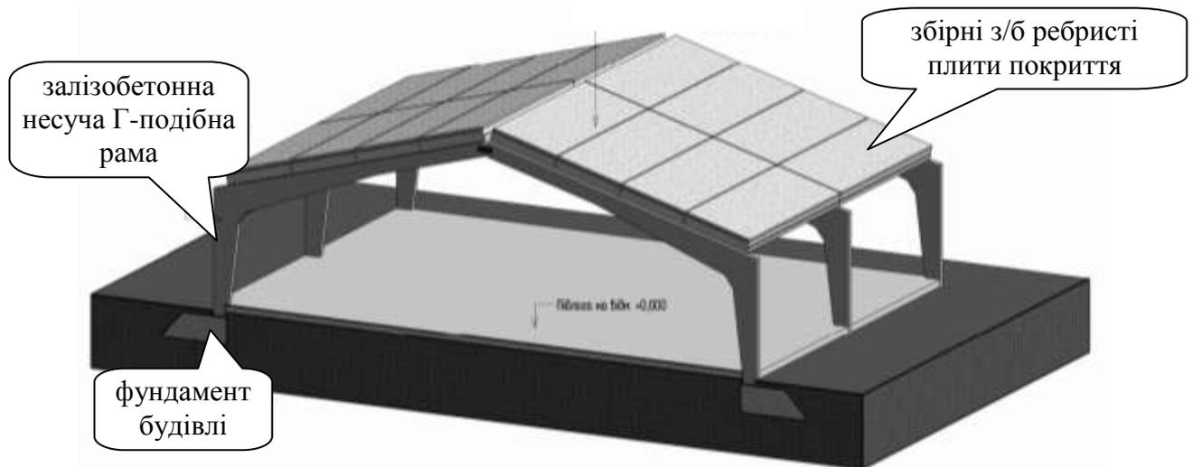
Рис. 6.4 – Рамна конструктивна схема швидкокомтованих будівель
