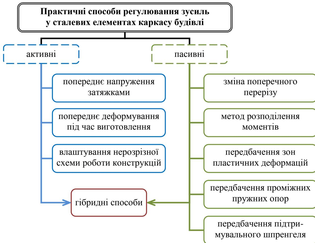
Рис. 1.30 – Практичні способи регулювання зусиль у сталевих конструкціях
