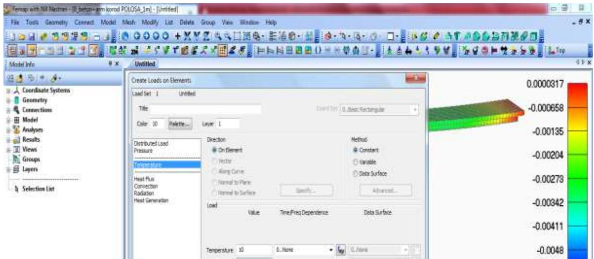
Рис. 5.11 – Діалогове вікно під час створення температурних напружень в сталевій частині перерізу СЗБ перекриття
