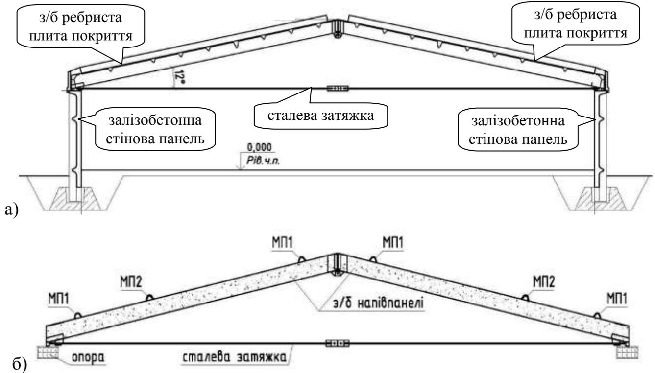
Рис. 6.1 – Загальний вигляд залізобетонної трикутної кроквяної системи із сталеву затяжкою: а) у складі каркасу всієї будівлі;
