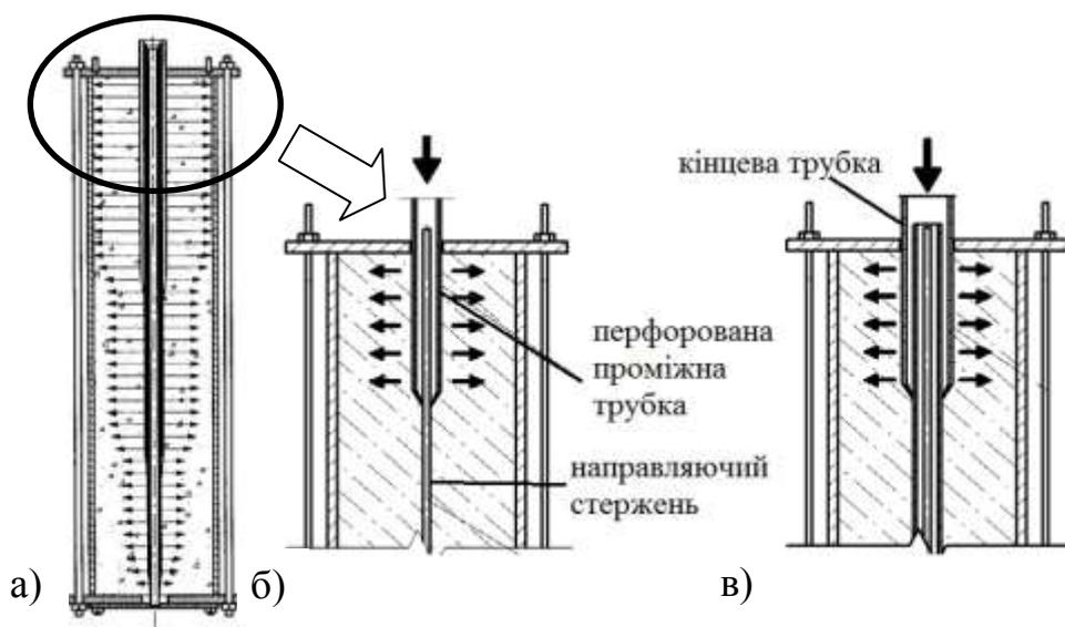
Рис. 1.28 – Зразки з попереднім обтиском бетонного ядра під час виготовлення [119]
