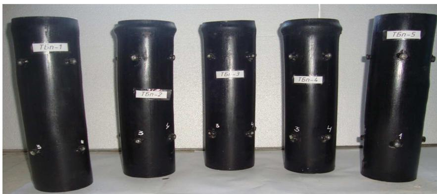
Рис. 4. Зразки серії ТБп (з штучно утвореними порожнинами) після випробування
