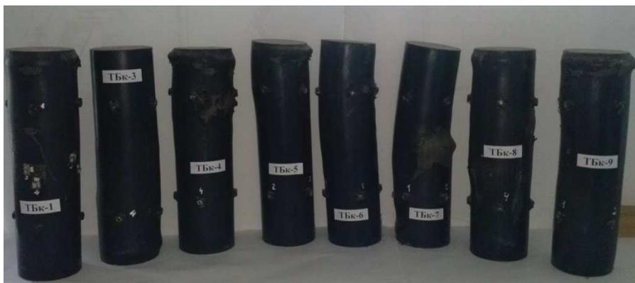
Рис. 3. Загальний вигляд дослідних зразків серії ТБк після випробувань
