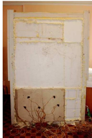
Рис. 5. Схема температурної камери: 1 – досліджуваний фрагмент; 2 – пінополістирол; 3 – температурна камера; 4 – джерело теплового потоку
