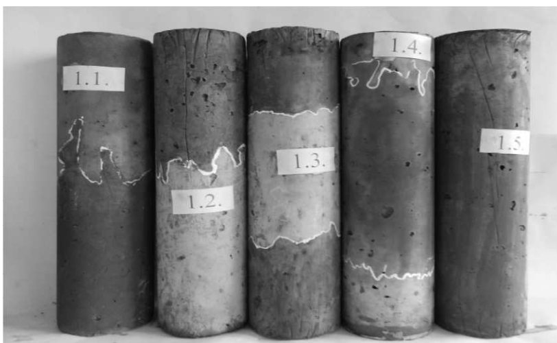
Рис.3. Серія зразків бетонних циліндрів висотою 4d з введенням пігменту
