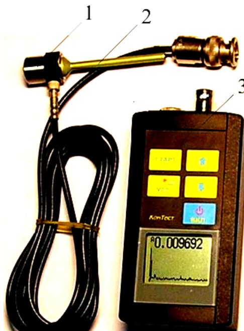
**Рис. 1. Прилад для вимірювання параметрів коливань “Віброметр 107В”:**
