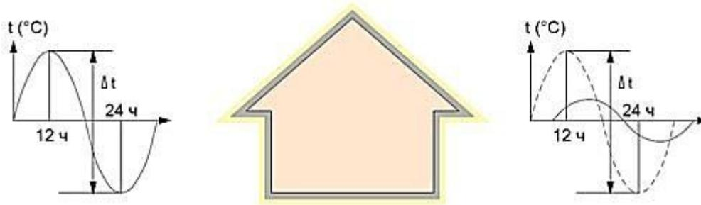
Рис.9.4 Явище зниження амплітуди та зміщення фази коливання температури у будинку з бетонними утепленими стінами
