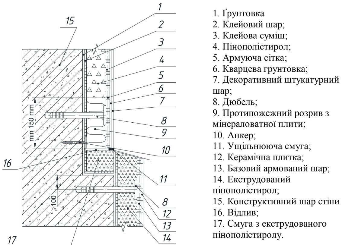
Рис. 15.17 Варіант примикання фасадної системи до цоколя (варіант 2)
