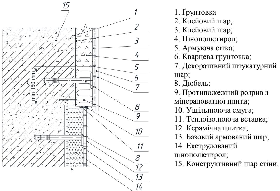
Рис. 15.16 Варіант примикання фасадної системи до цоколя (варіант 1)
