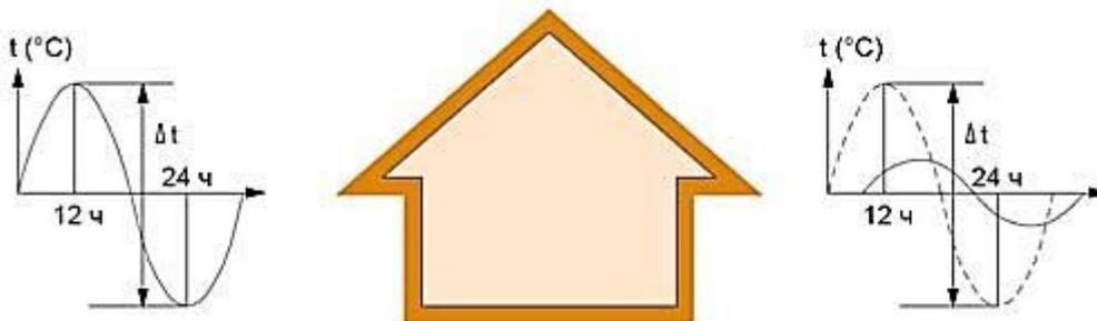
Рис. 9.5 Явище зниження амплітуди та зміщення фази коливання температури у будинку з однорідні кам'яні стіни з теплих керамічних блоків
