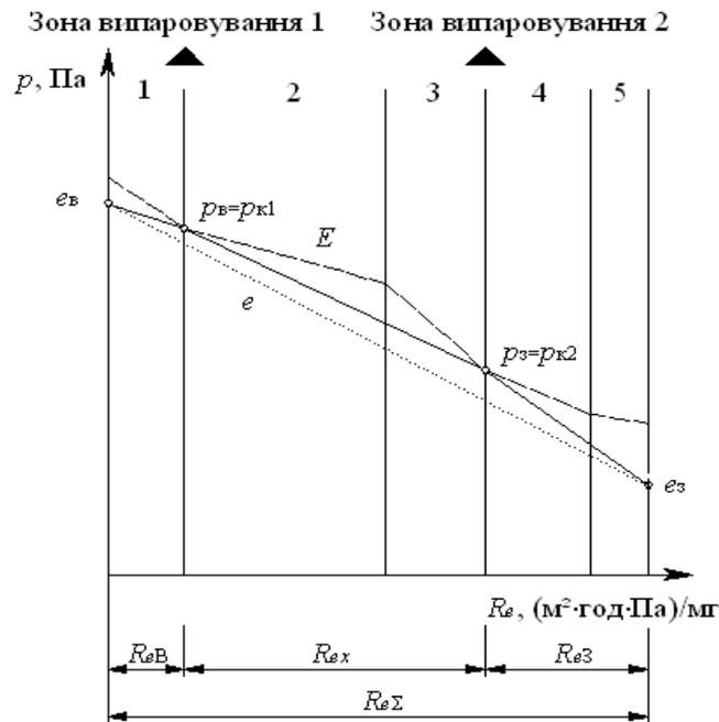
Рис. 13.11 Вологовіддача з огороження з двома зонами випаровування
