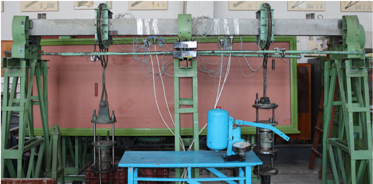
Рис. 3. Загальний вигляд установки для випробування нерозрізних балок
