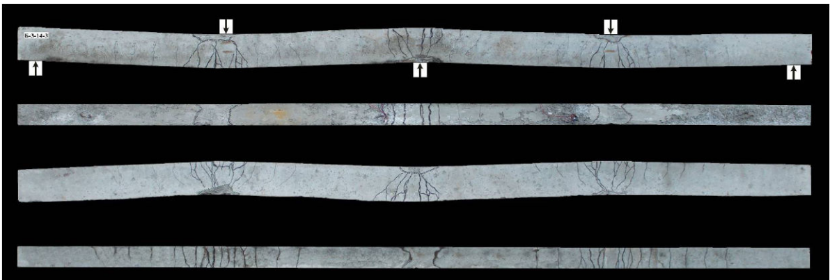
Рис. 4. Характер розвитку тріщин та руйнування експериментальних зразків
