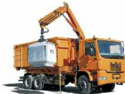
Рис. 5.10.4. Портальний сміттевоз на базі шасі КрАЗ-5401Н2 з високоефективним газовим двигуном М906LАG екологічного класу “Євро 5”, із змінним контейнером ємністю 8 м<sup>3</sup>
