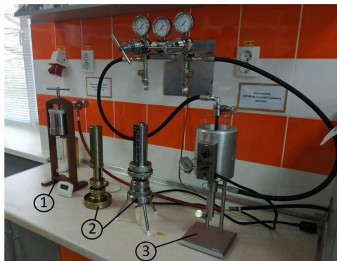
**Рисунок 1 – Визначення фільтраційних властивостей бурового розчину в умовах високої температури і високого тиску**
