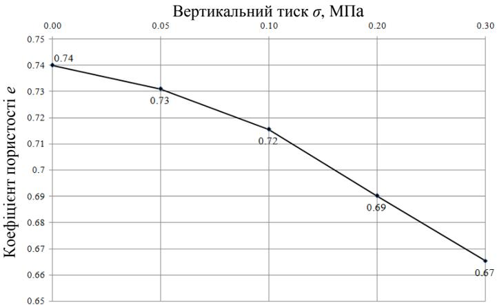
Рис. 3. Компресійна крива досліджень (при проценті армування  $i = 2,2\%$ )
