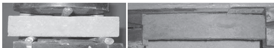
Рис. 6. Випробування грунтоцементу на розтяг: зразків-балочок на розтяг при згині (зліва) та призм на розрив (справа)
