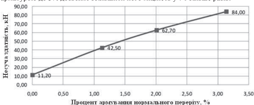
Рис. 4. Графік залежності несучої здатності дослідного зразка від процента армування
