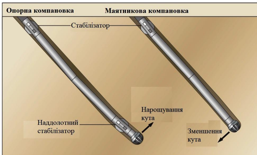
Рис. 3. Використання опорної та маятничкової КНБК для зміни нахилу свердловини
