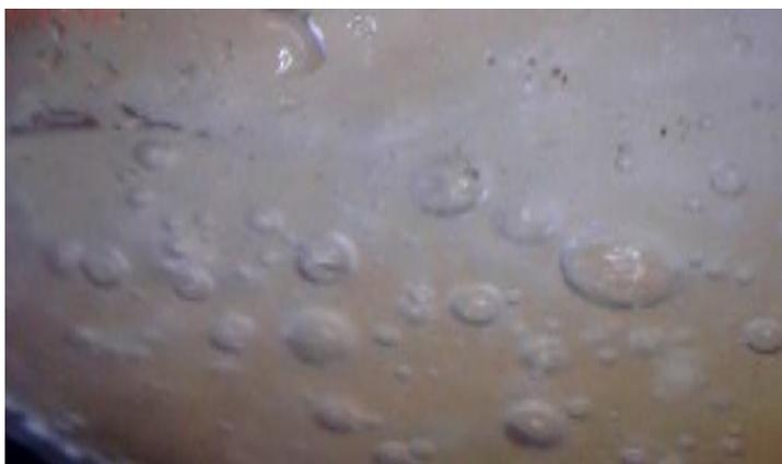
*Рисунок 3.16 – Уповільнена дисоціація попередньо утвореної твердої фази при контактуванні 70% розчині метанолу газової суміші ( $P = 0,6$  МПа,  $T = - 32^{\circ}\text{C}$ )*
