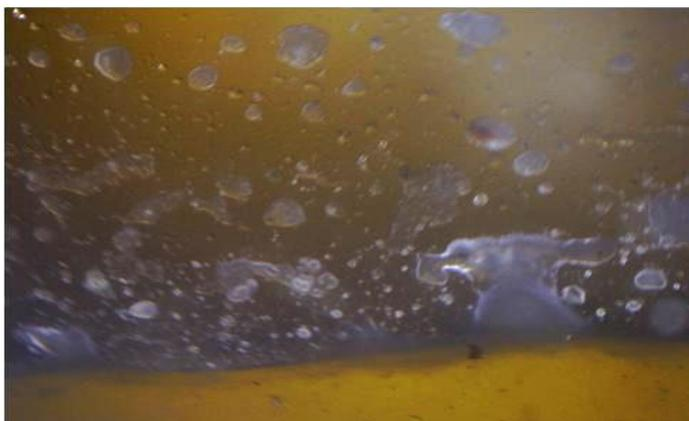
*Рисунок 3.9 – Приклад «засмічення» краплями рідини поверхні оглядового вікна реактора (фото автора в процесі досліджень)*
