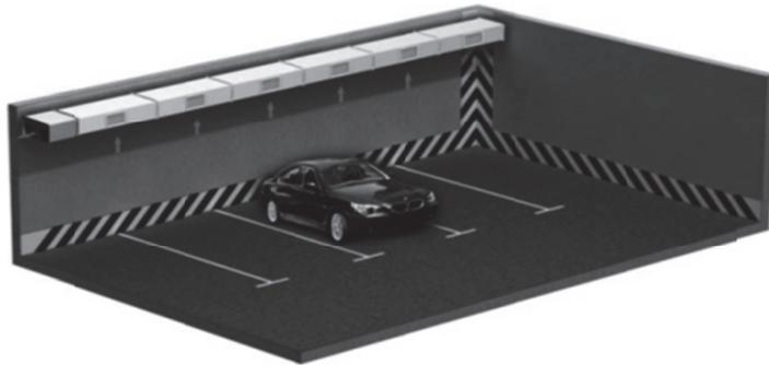
Рис. 5.1. Варіант улаштування загальнообмінної витяжної системи вентиляції паркінгу
