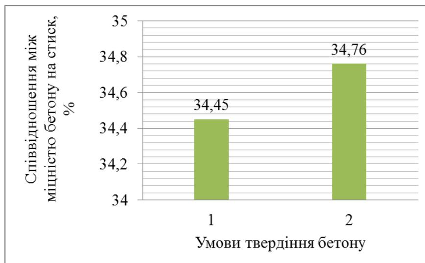
Рис. 9. Співвідношення між міцністю бетону на стиск у віці 1 доби (твердіння – без використання теплової обробки) та міцності бетону у віці 28 діб, твердіння якого відбувалося: 1 – в нормальних температурно-вологісних умовах; 2 – в повітряних умовах
