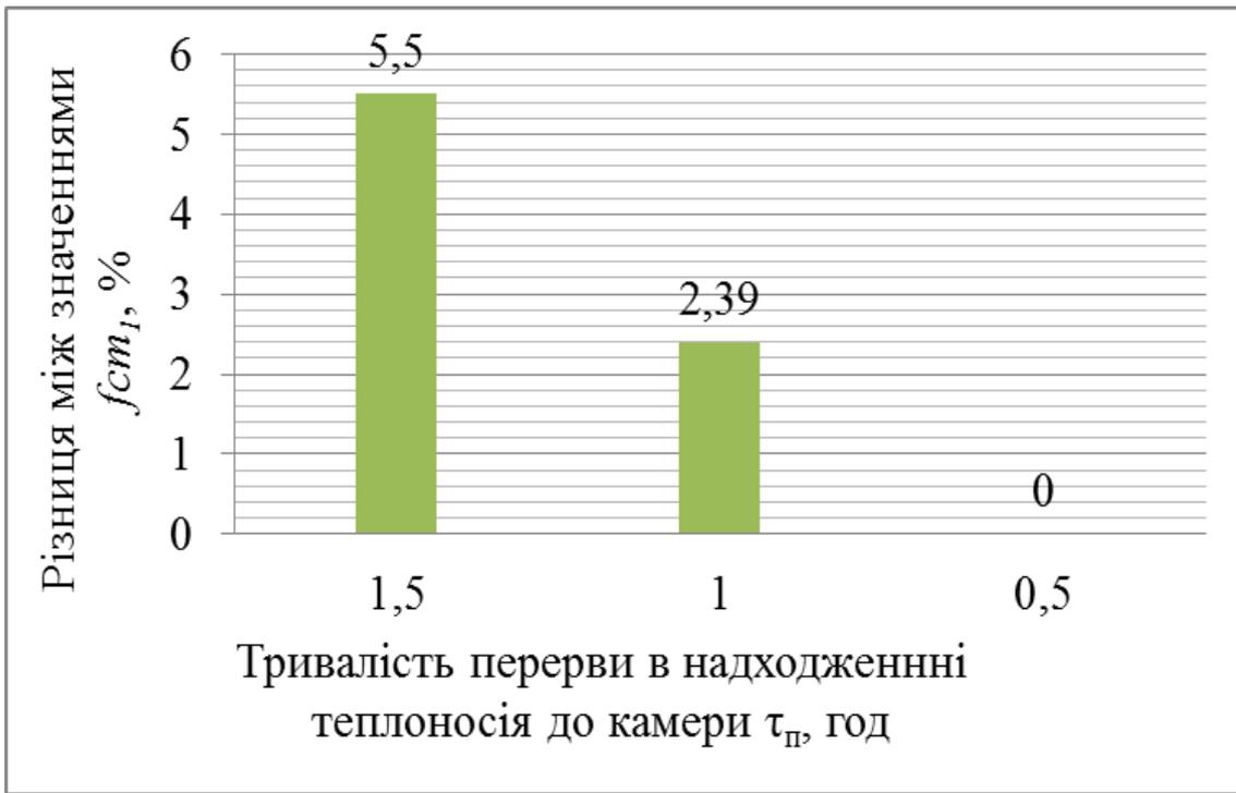
Рис. 4. Різниця між міцністю бетону на стиск у віці 1 доби при  $\Delta t_1=6\text{ }^\circ\text{C}$ , якщо за 100 % прийнято  $f_{ct1}$  при  $\tau_p=0,5$  год (точка плану 8)
