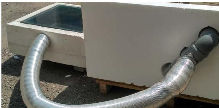
Рис. 1. Компонування установки для теплової обробки плиток бетонних тротуарних
