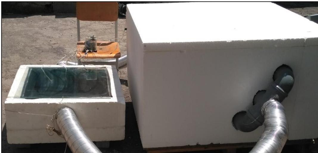
**Рис. 1:** Використання колектора сонячної енергії для теплової обробки плит бетонних тротуарних
