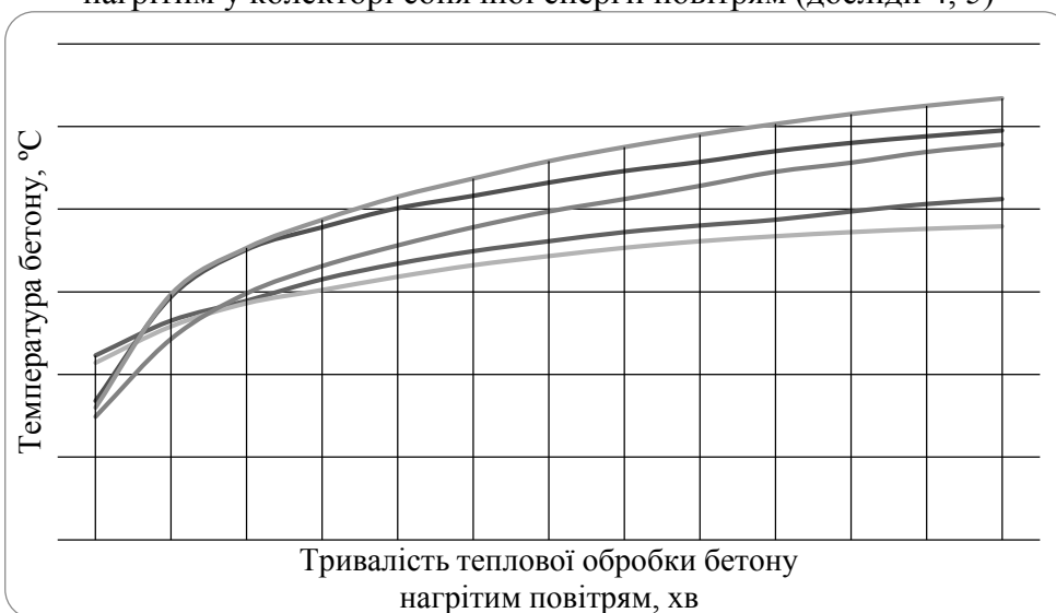
Рис. 10. Зміна температури бетону при його тепловій обробці нагрітим повітрям (досліди 1 – 5)
