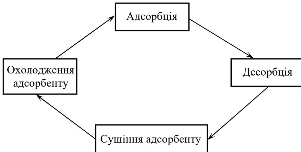
Рис.12.7. Принцип роботи адсорберів з нерухомим поглинальним шаром
