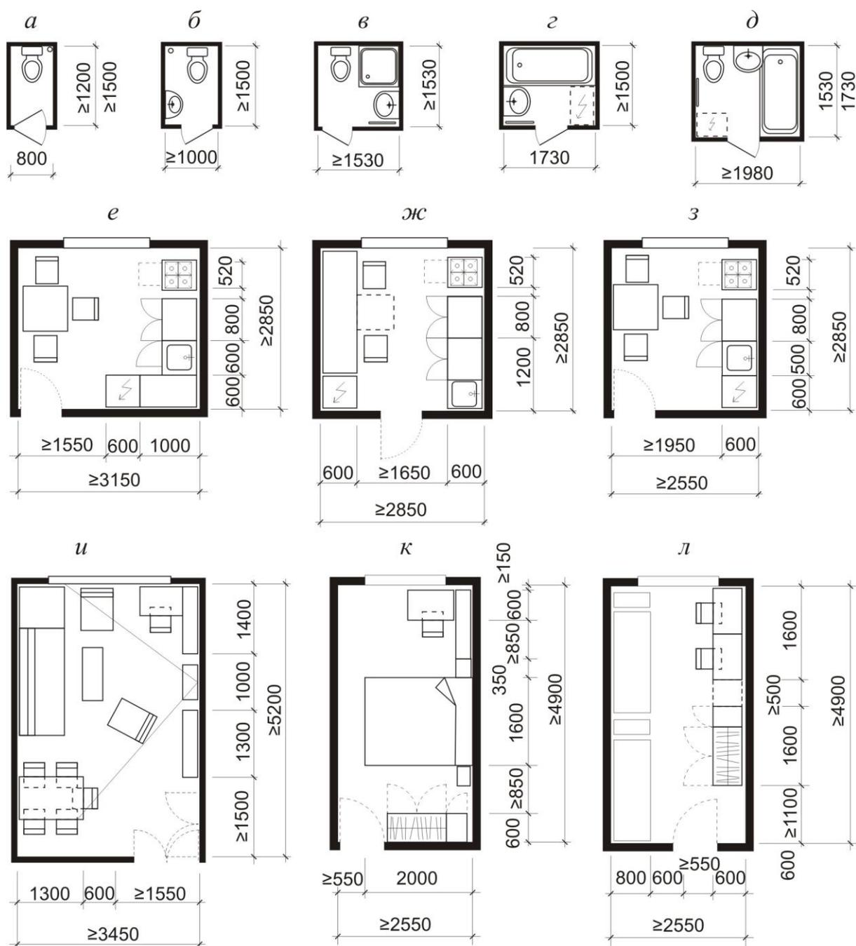
Рис. 2.16. Визначення найменших габаритів приміщень (на прикладах окремих приміщень квартири):
