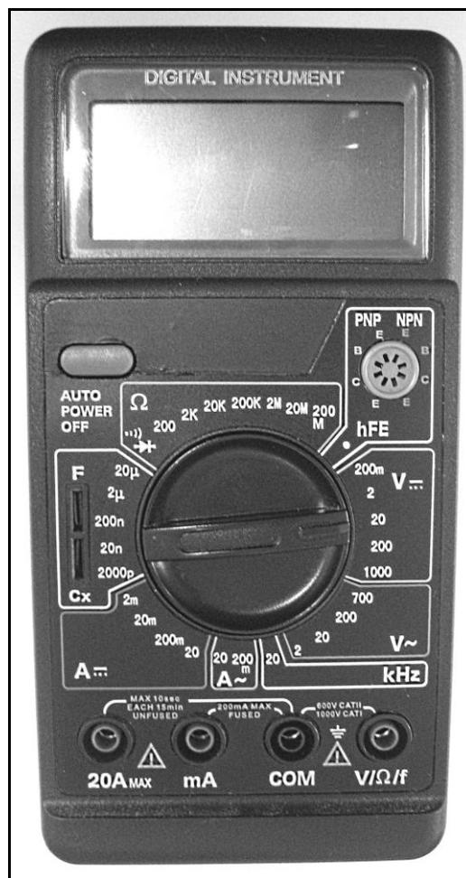
*Рис. А.9. Зовнішній вигляд мультиметра*
