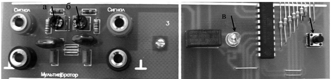
Рис. 3.11. Фрагмент стенда ЛС-2 «Дослідження мультивібратора»:
