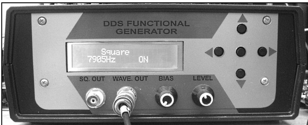
*Рис. А.6.* Зовнішній вигляд функціонального генератора
