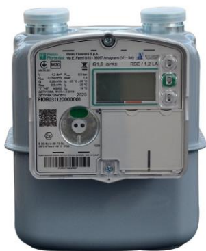
Рис.1 Smart лічильник газу RSE/1,2 LA G1,6 TM Pietro Fiorentini виробництва Pietro Fiorentini S.p.A. (Італія) — це смарт-лічильник газу з вбудованим температурним пристроєм перетворення об'єму.
