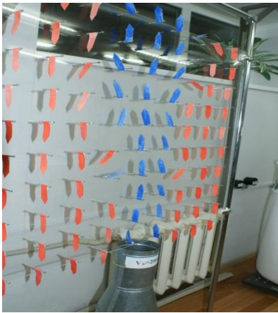
Рис. 2. Фото візуалізатора на стендах факельного викиду
