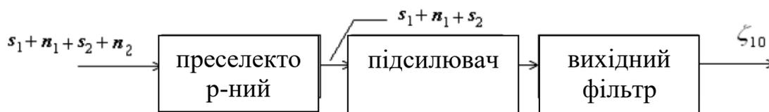
Рисунок 1 - Схема аналітичної частини радіоприймального пристрою
