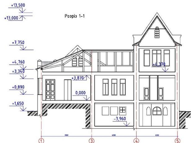
Рис. 2. Переріз будівлі
