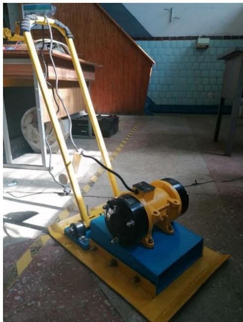
Рисунок 1 – Вібраційна плита
