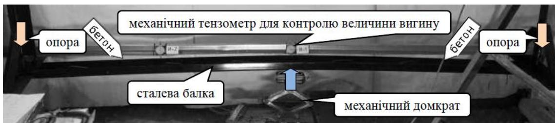
Рис. 1. Попередній вигин сталеві частини перерізу балки
