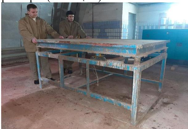
Рис. 1. Вібростіл з важільним закріпленням віброзбуджувача
