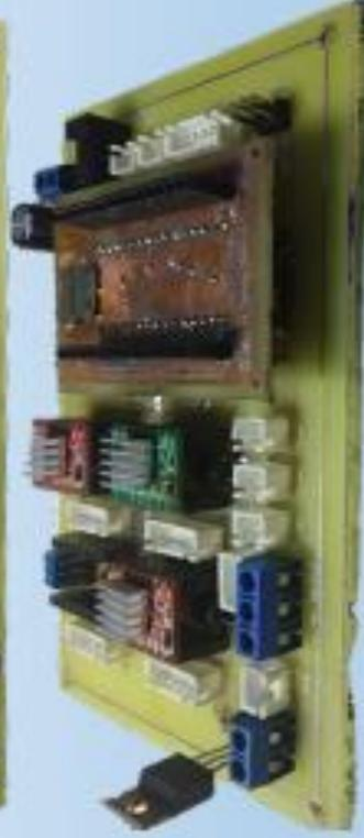
Практична реалізація плата розширення для МК Arduino Nano та ESP32 з перехідною платою
