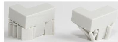
Рис. 1.3. Супорти для FDM: а) – «акордеон»; б) – «дерево»
