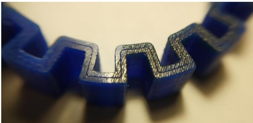
*Рис. 1.24. Оброблений прототип фрактального антенного елемента з кроком в 5 кроків/мм*
