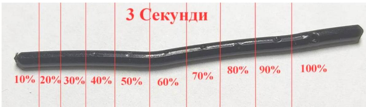
*Рис.1.23. Вплив лазерного випромінювання на тестовий зразок PETG*
