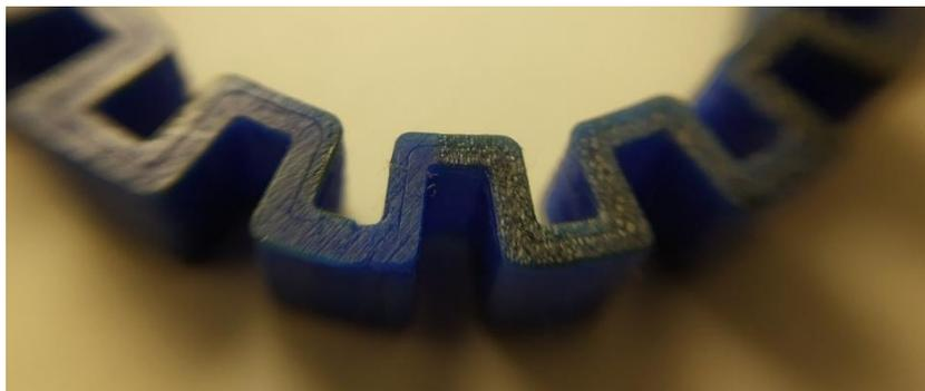
*Рис. 1.25. Оброблений прототип фрактального антенного елемента з кроком в 15 кроків/мм*
