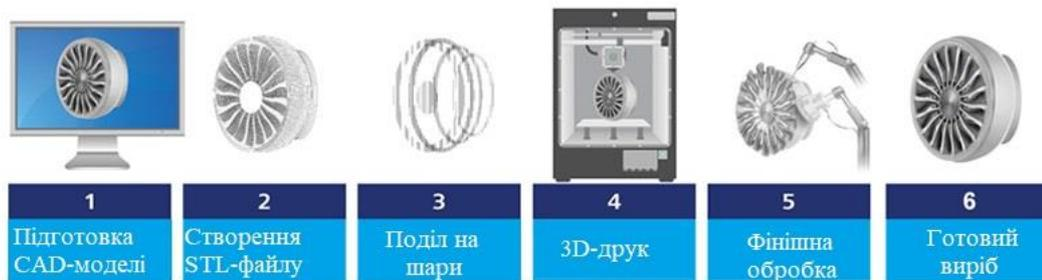
*Рис. 1.1. Схема адитивного виробництва*
