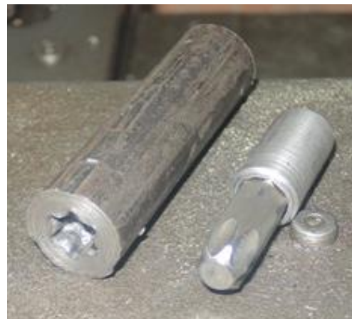
Рисунок 2 – Виготовлення профільних отворів шляхом ротаційного видавлювання: а – спосіб виготовлення; б – одержаний профільний отвір та біта
