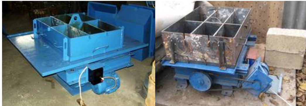
Рисунок 12 – Ударно-струшувальна установка для формування арболітових виробів
