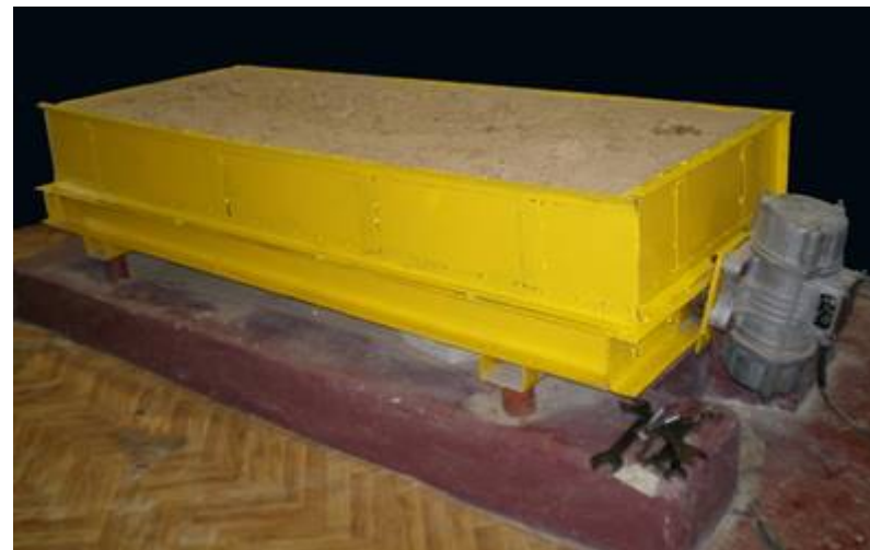
Рисунок 14 – Вібраційна установка з похилим віброзбуджувачем для формування довгомірних залізобетонних виробів
