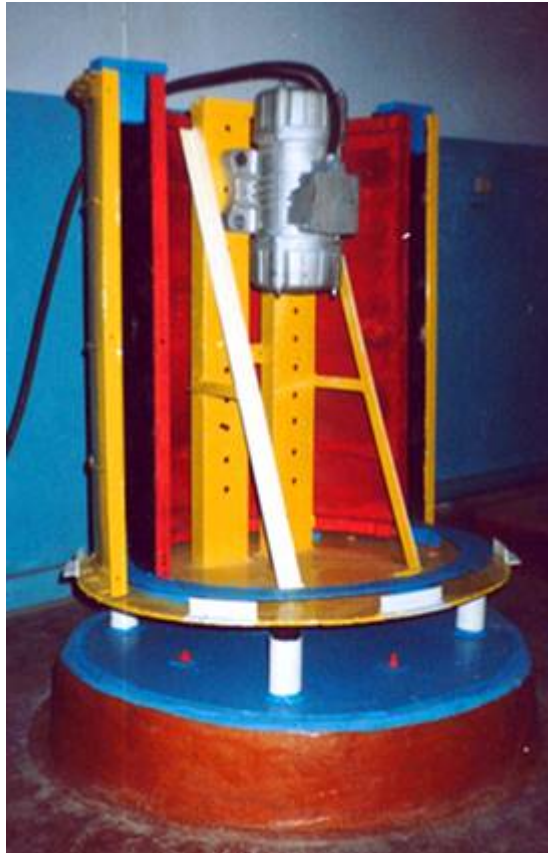
Рисунок 11 – Вібраційна установка з просторовими коливаннями для формування трубчастих виробів (залізобетонних кілець)
