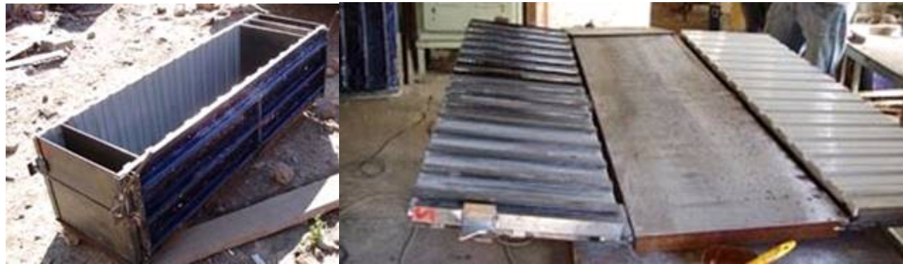
Рисунок 13 – Розбірна касетна форма для формування залізобетонних виробів
