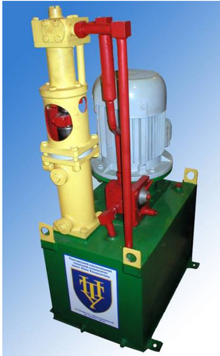
Рисунок 10 – Гідропривідний розчинонасос РНГ-4
