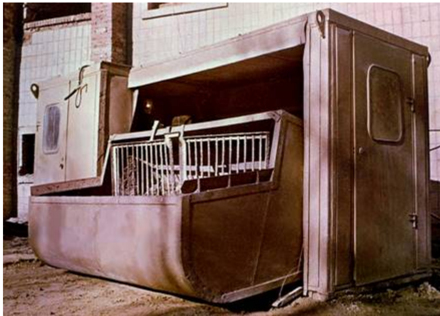
Рисунок 1 – Штукатурна станція СШ-4
