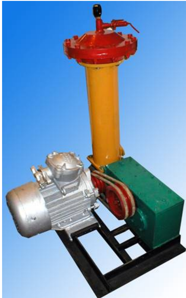
Рисунок 9 – Однопоршневий розчинонасос РН 3,8 із комбінованим компенсатором пульсації тиску
