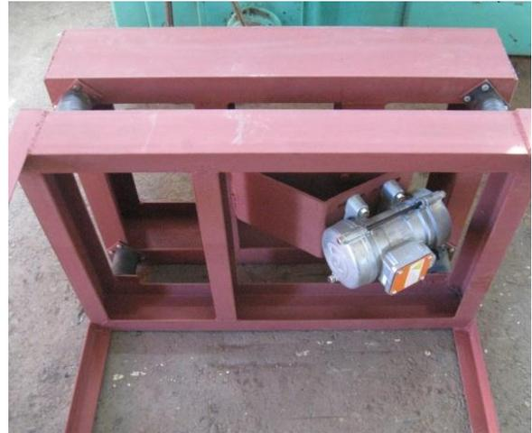
**Рисунок 10** – Віброустановка з формою для виготовлення поребриків
