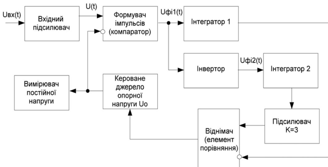
Рис. 3. Структурна схема пристрою для реалізації вдосконаленого фазочастотного методу вимірювання амплітуди змінної напруги синусоїдальної форми
