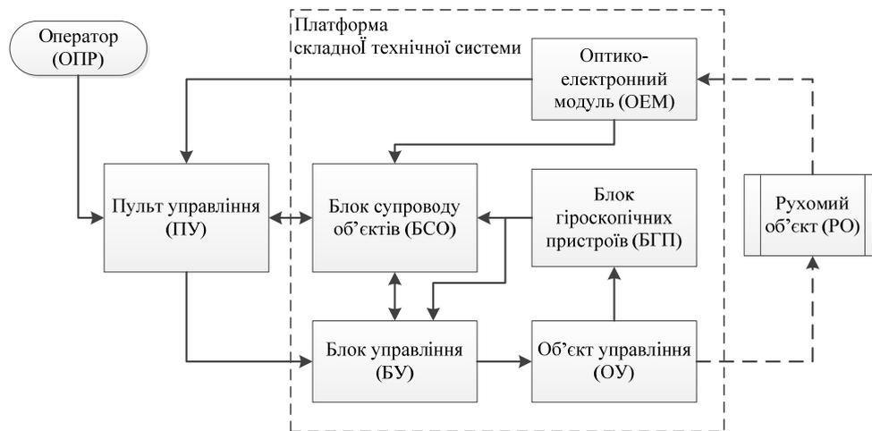
Рис. 1. Блок-схема системи управління складною технічною системою
