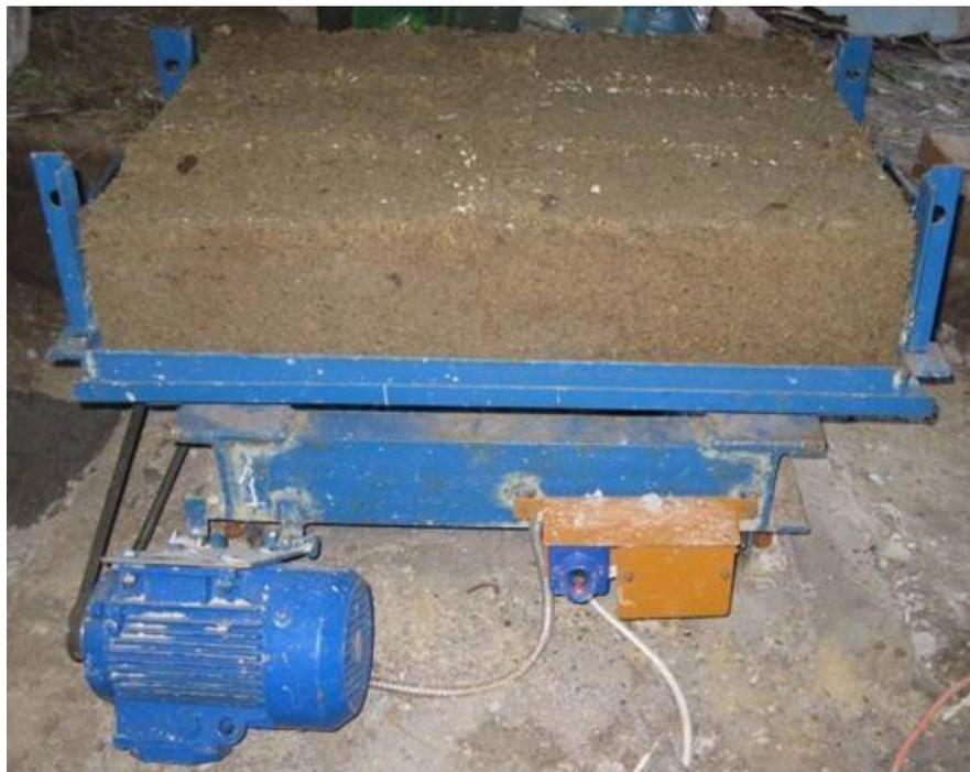
Рис. 2. Ударно-вібраційна установка
