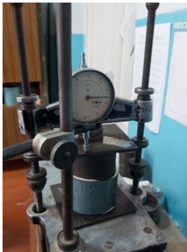
Рисунок 1 – Схема віброопори з обмежувачами вільної частини пружного елемента опори
