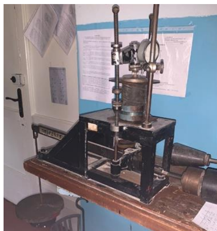
Рисунок 2 – Вимірювання навантаження на віброопору з металевим обмежувачем
