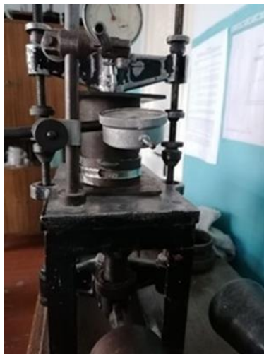
Рисунок 1 – Схема віброопори з обмежувачами вільної частини пружного елемента опори
