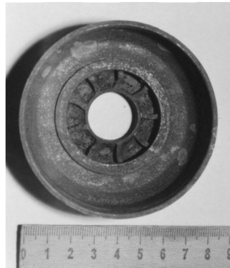
Рис. 1. Пошкодження робочого колеса і струмененаправляючого апарату відцентрових електронасосів
