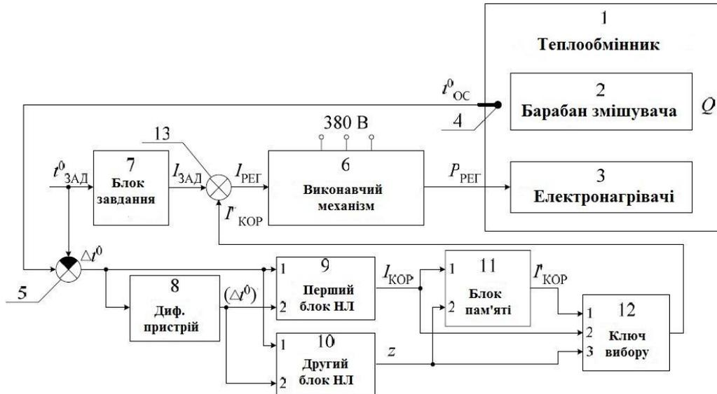
Рис. 1. Структурна схема системи нечіткого регулювання температури
