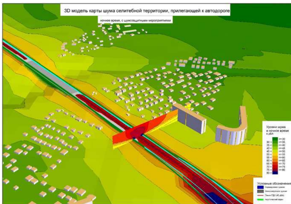
Рис. 2.3 - Тривимірна карта шуму, побудована з використанням програмного комплексу SoundPLAN
