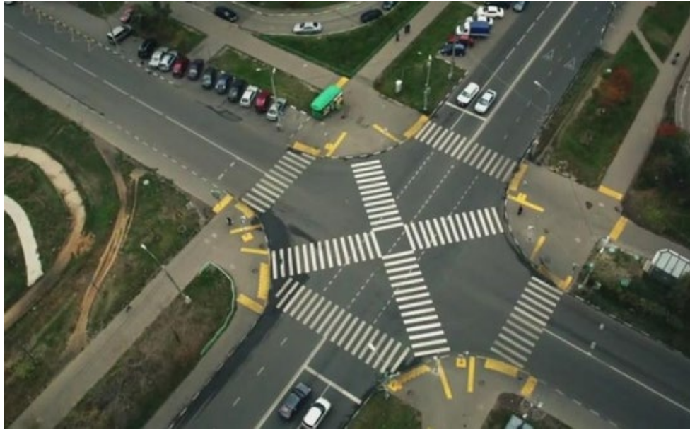
Рис. 1.25. Приклад застосування діагонального пішохідного переходу з урахуванням потреб людей, які пересуваються на кріслах-колісних та інших маломобільних користувачів
