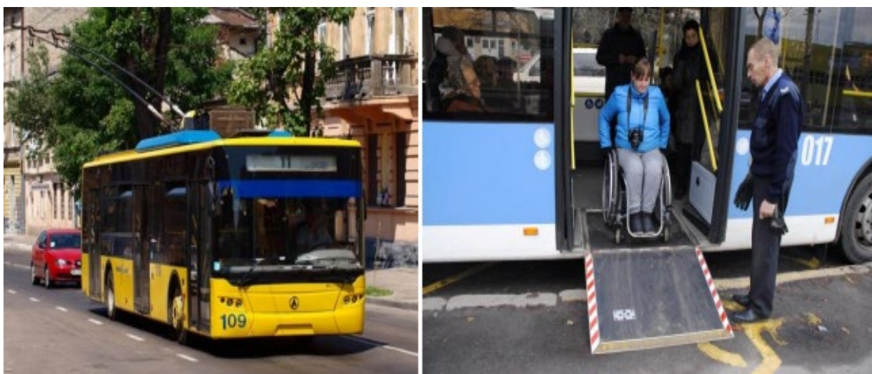
Рис. 3. 9 Приклад тролейбусу пристосованому для потреб людей які використовують інвалідні візки та за допомогою якого людина може швидше переміщатися містом
