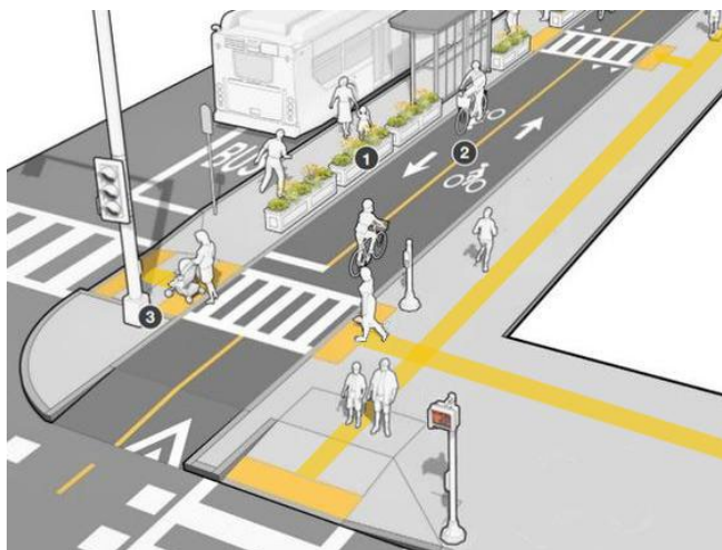
Рис. 2.5 Застосування інформаційної ТС на наземних пішохідних переходах
