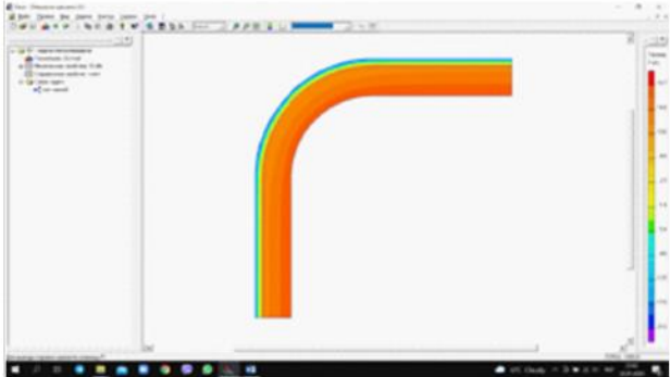
Температурне поле стіни при товщині стіни 380 мм, товщині утеплювача 100 мм, з радіусом заокруглення 1,5 м
