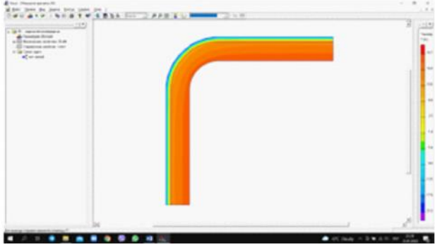
Температурне поле стіни при товщині стіни 380 мм, товщині утеплювача 100 мм, з радіусом заокруглення 1,5 м
