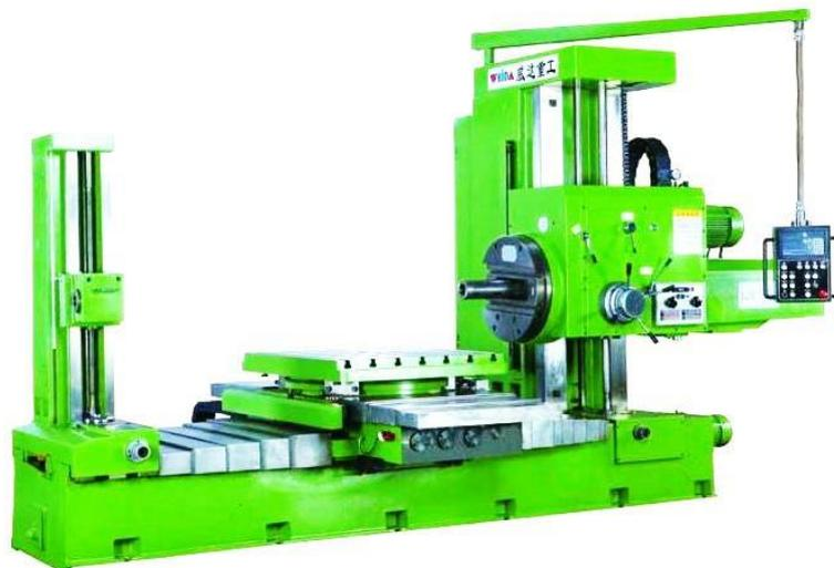
Рисунок 1.3 - Горизонтально-свердлильний верстат СвГД
