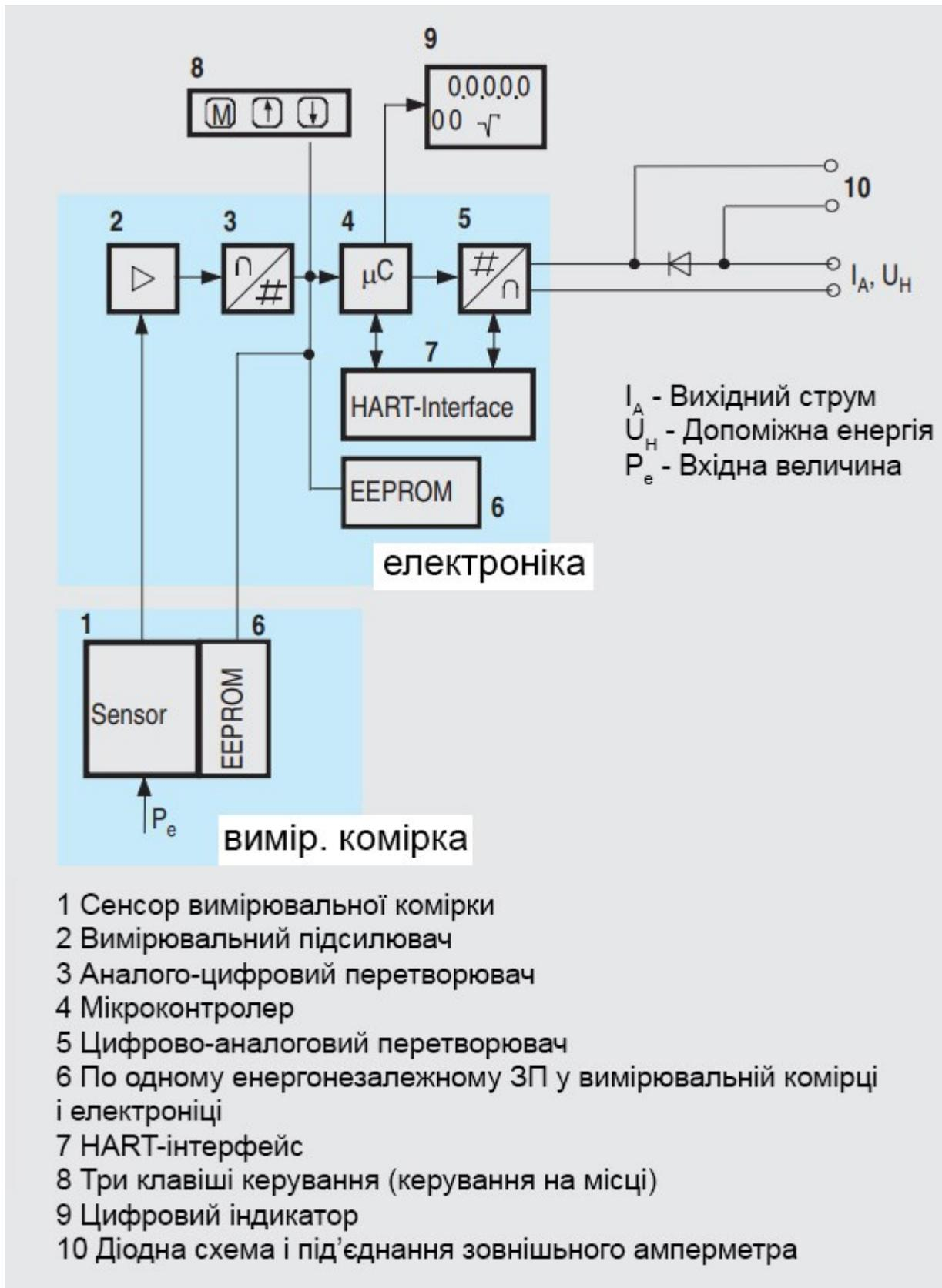
Рисунок 2.1.13 – Схема електроніки SITRANS P DS III
