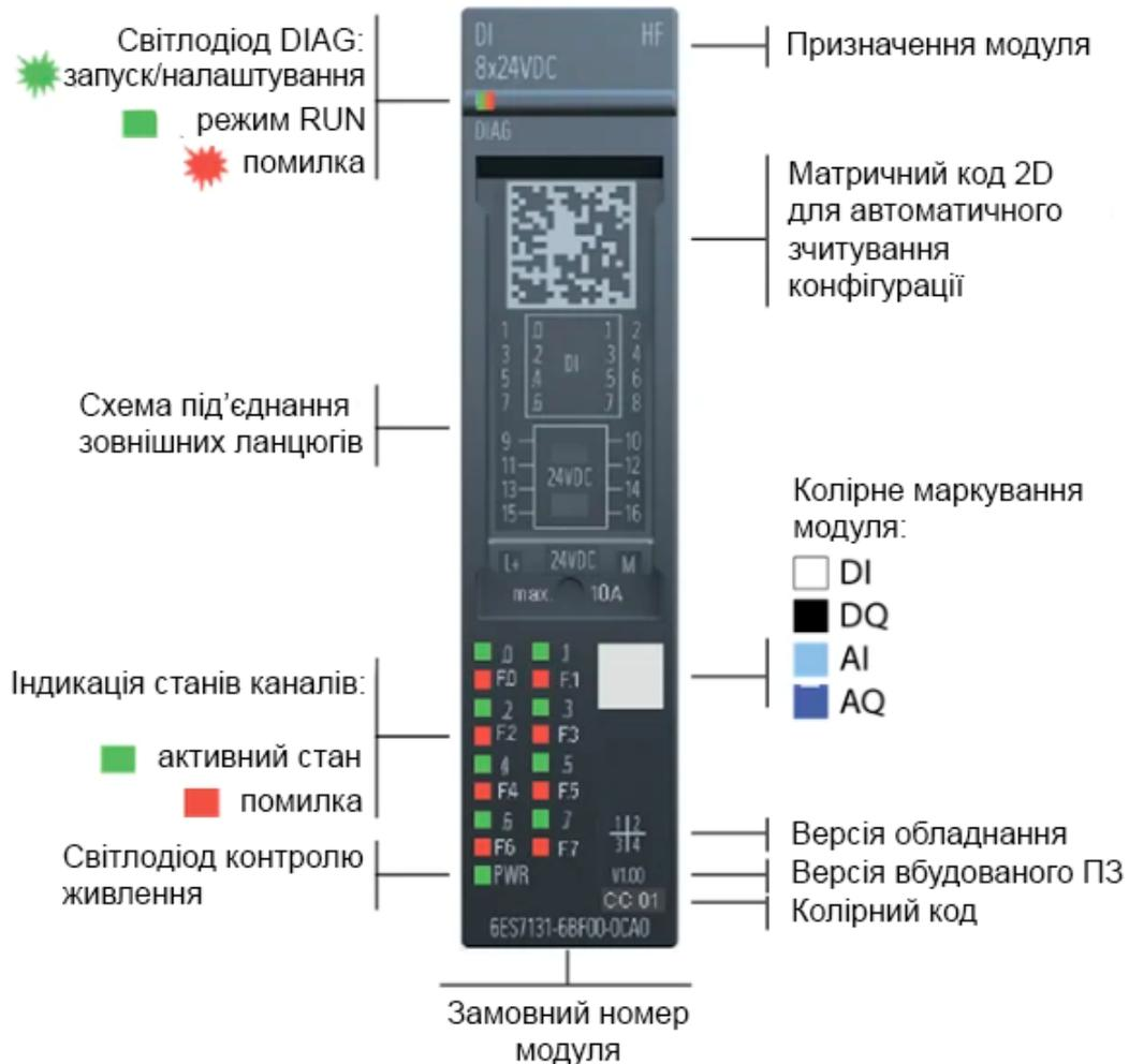
Рисунок 2.1.11 – Загальний вид модуля
