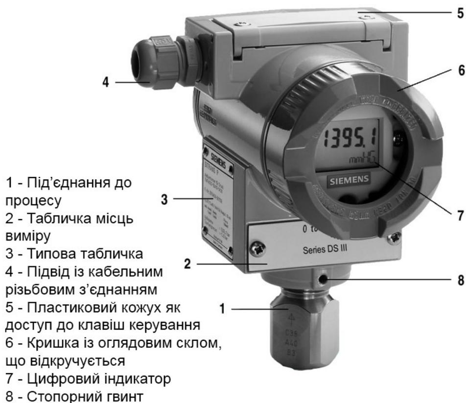
Рисунок 2.1.12 – Конструкція SITRANS P DS III, вид спереду
