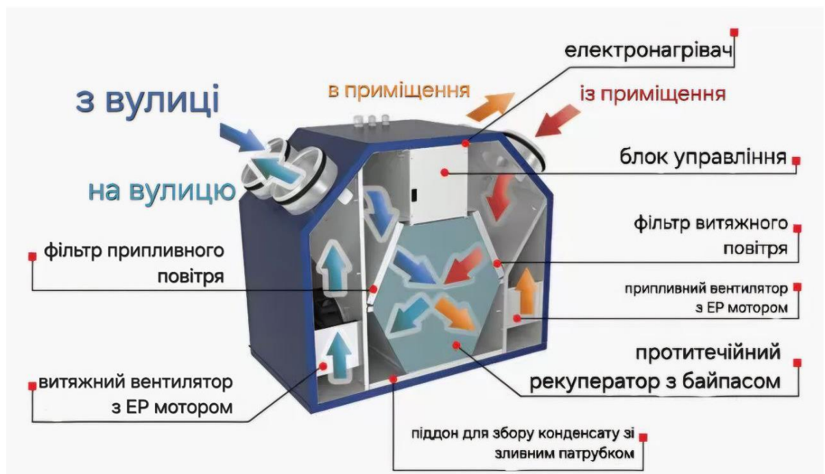
Рис. 2.8. Схема руху повітря та основні елементи рекуператора
