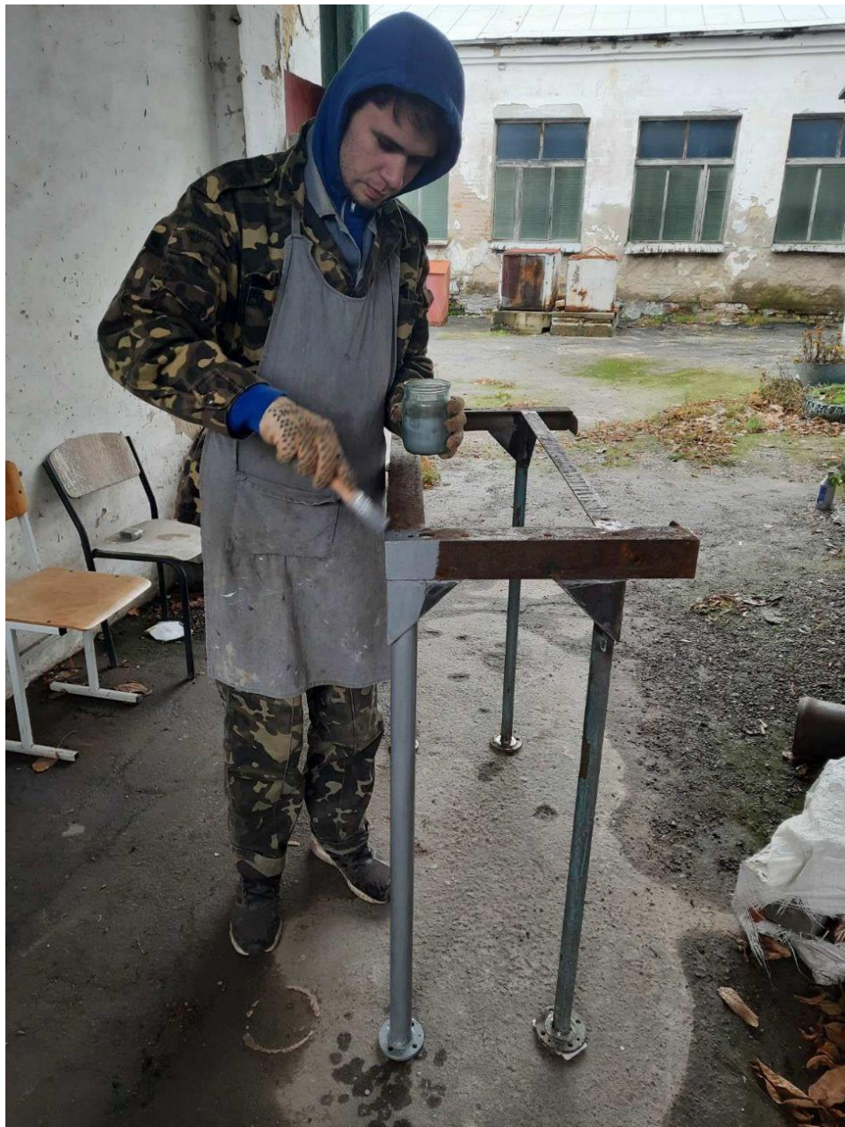
Рис. 4.3. Покриття фарбою готової стійки.
