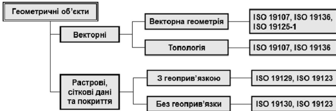
Рис. 1.2. Структура стандартів серії ISO 19100, що визначають класи геометричних об'єктів для подання просторових властивостей і топології географічних об'єктів
