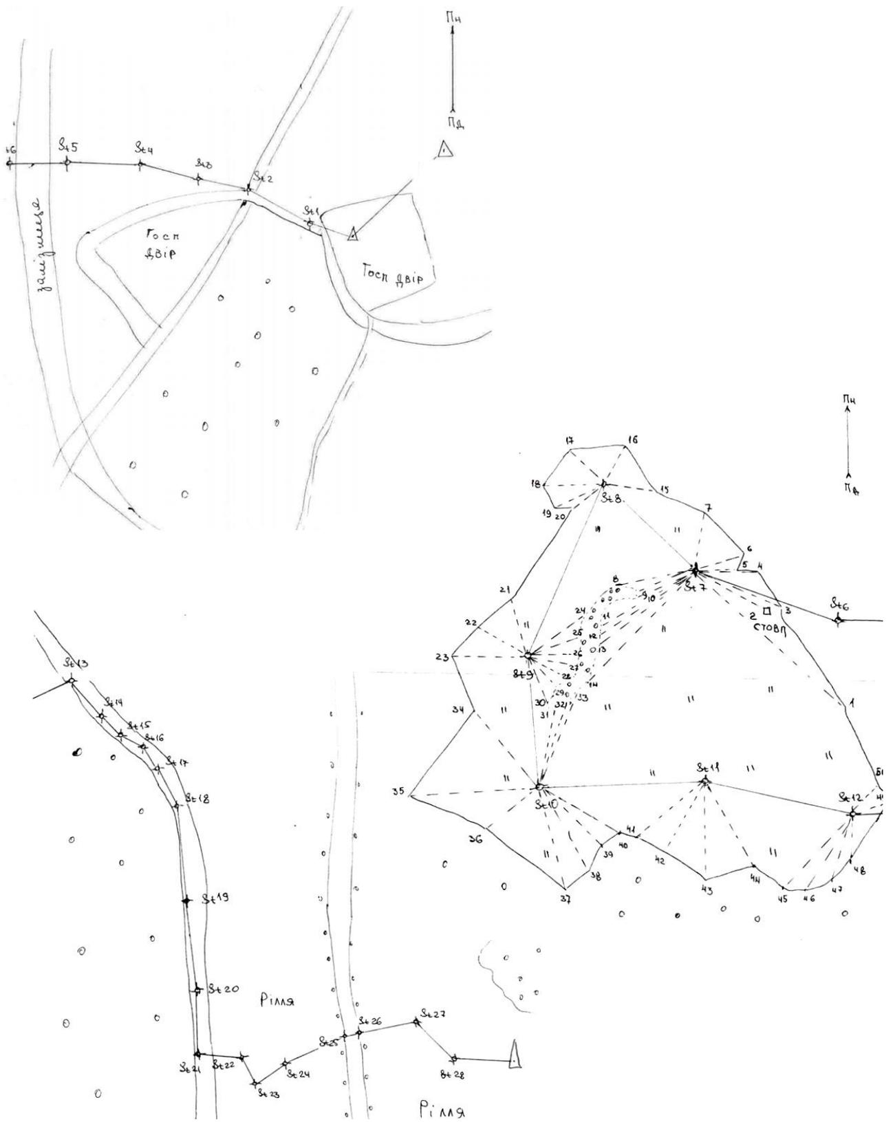
Рисунок 3.2 – Абрис тахеометричного знімання
